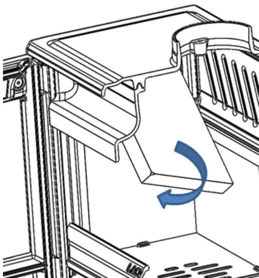
*Figura nº13 - Extração dos defletores de vermiculita*
