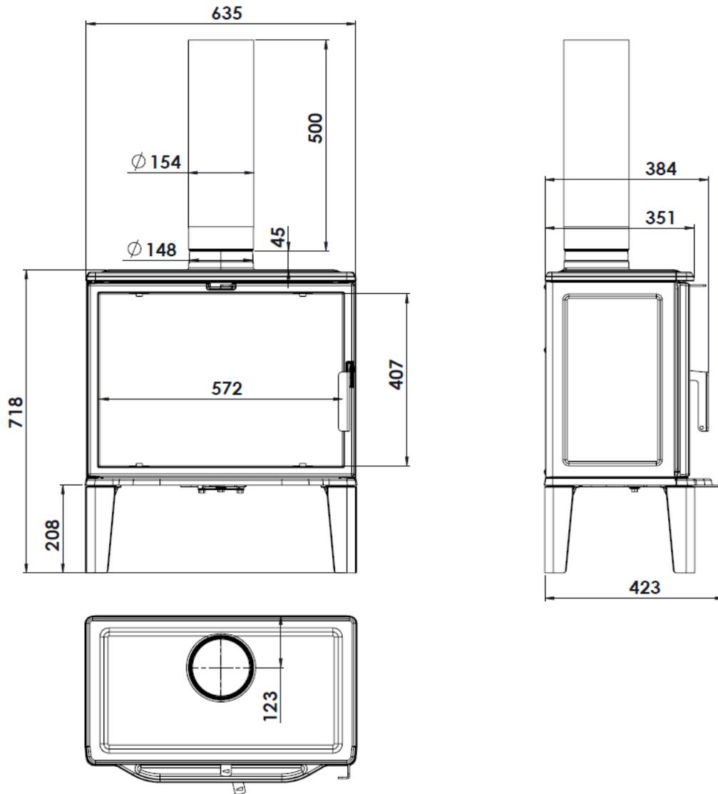
Figura nº1 - Dimensões em mm do aparelho Biarritz
