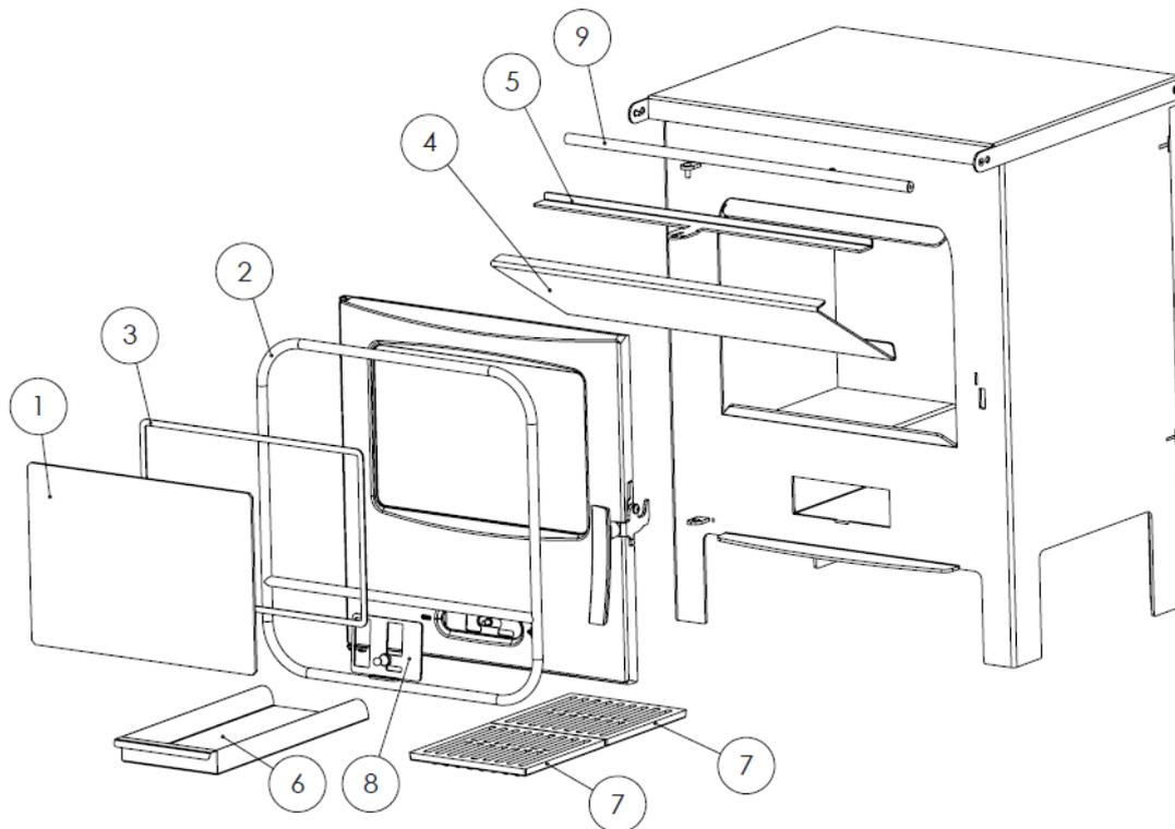
Figure nº15 - Pièces détachées Sagra CP
