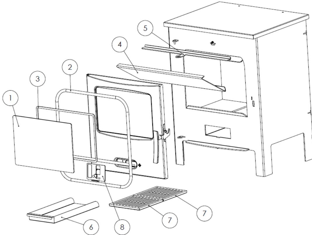
Figure nº14 - Pièces détachées Sagra
