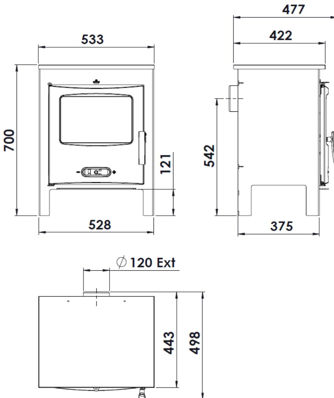
Figure n°1 - Dimensions en mm de l'appareil Sagra
