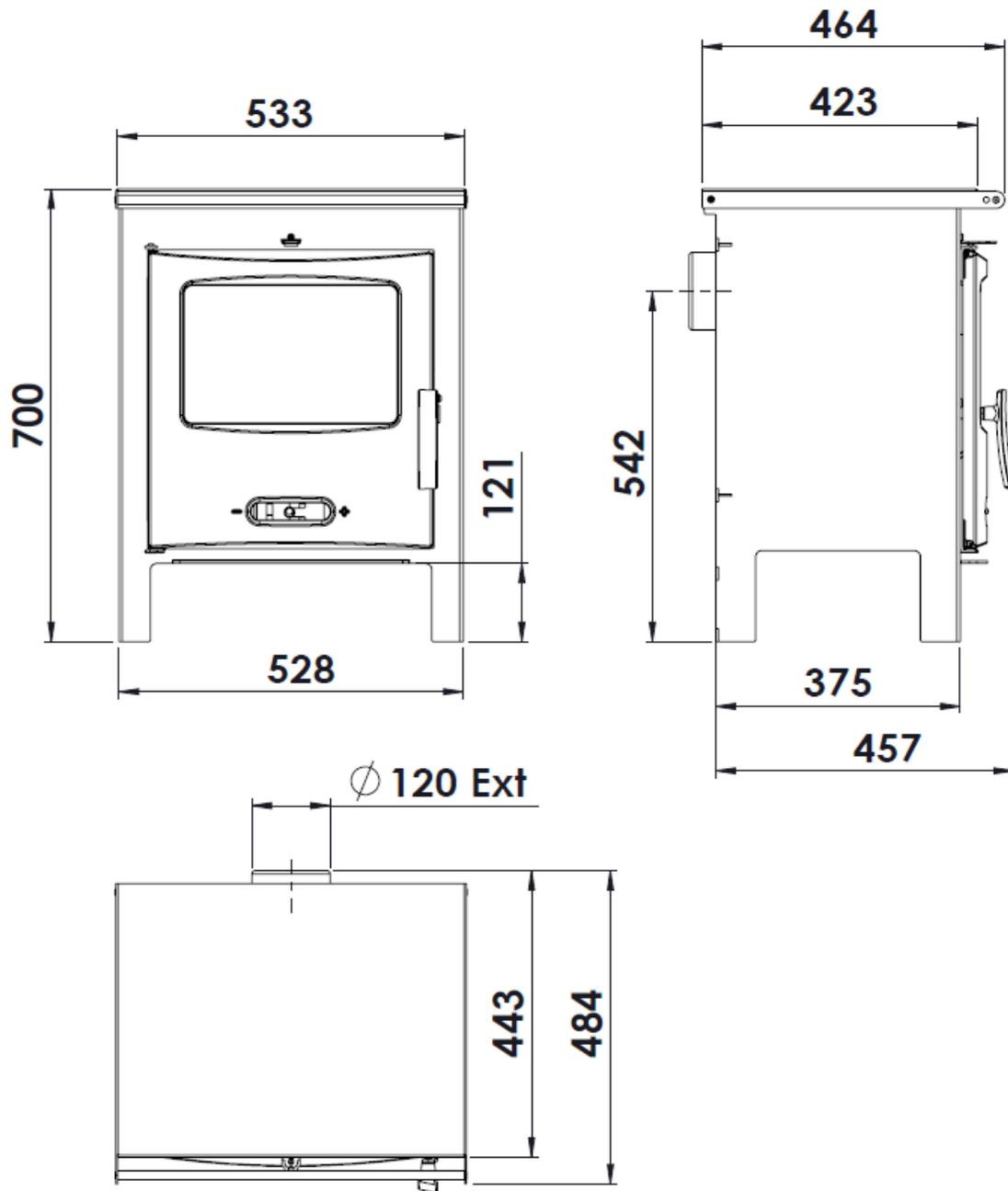
Figure n°2 - Dimensions en mm de l'appareil Sagra CP
