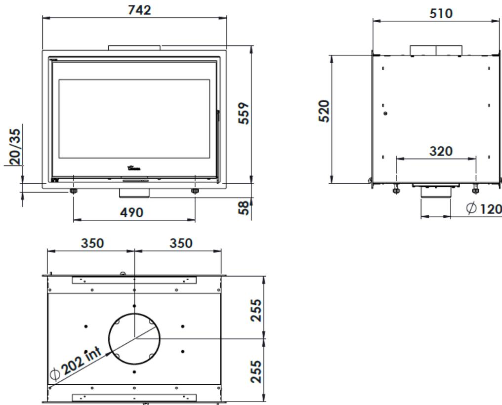
Figure n°2 - Dimensions en mm de l'appareil Nickel 800 DC
