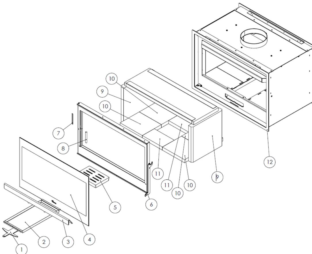
*Figure n°23 - PIÈCES DÉTACHÉES NICKEL 700/800 DC*
