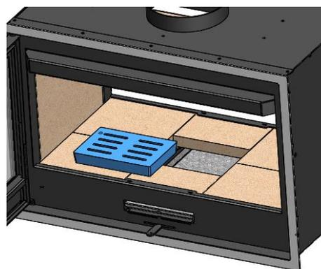
*Figure n°17 - Nous extrayons la grille en fonte*
