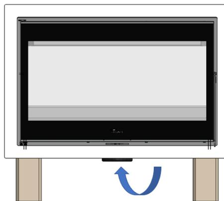
Figure n°8 - Conduction de l'air pour la chambre de combustion.
