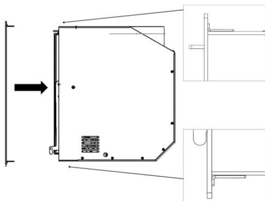
Figure n°10 - Passez l'encadrement par l'intérieur
