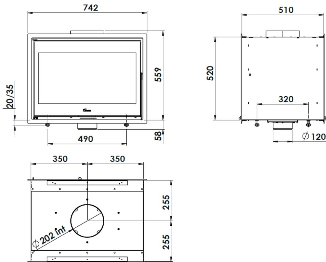
Figure n°1 - Dimensions en mm de l'appareil Nickel 700 DC
