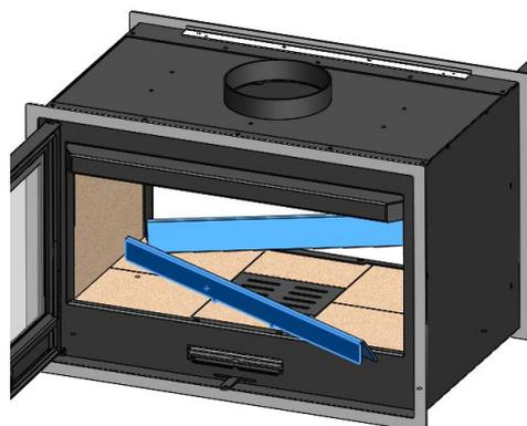
*Figure n°16 - Nous extrayons les deux séparateurs de la chambre de combustion*
