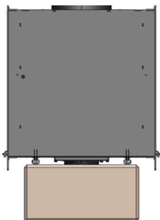
Figure n°5 - L'appareil doit être placé sur un socle pour permettre le passage de l'air pour la combustion.
