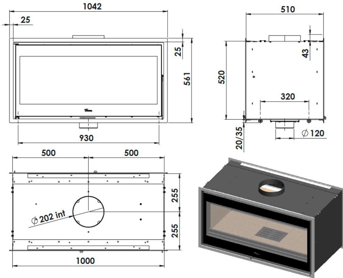
Figura nº3 - Dimensiones en mm del aparato Nickel 1000 DC
