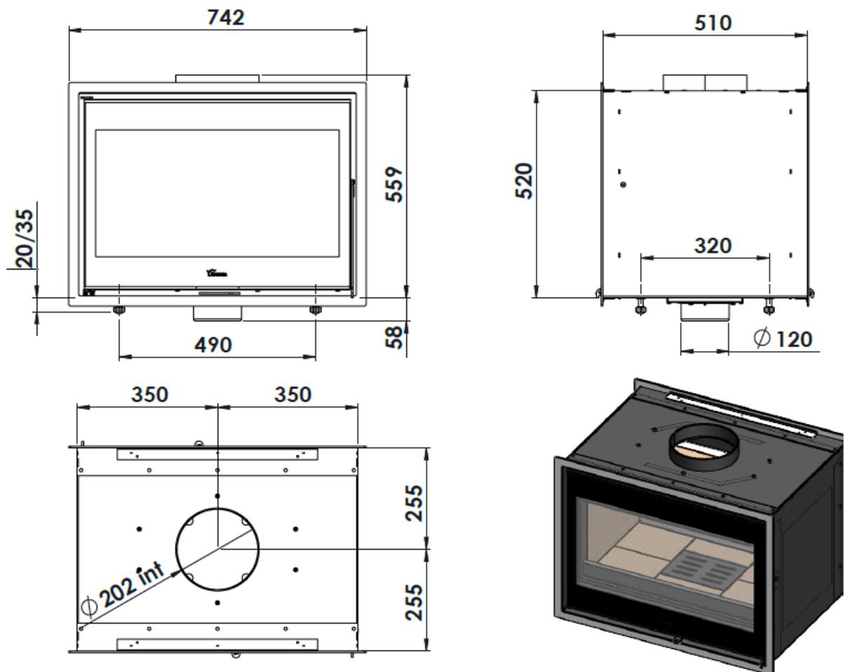
Figura nº1 - Dimensiones en mm del aparato Nickel 700 DC
