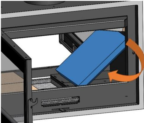
Figura n°21 - Abatimos el refractario lateral para que pueda caer el deflector.
