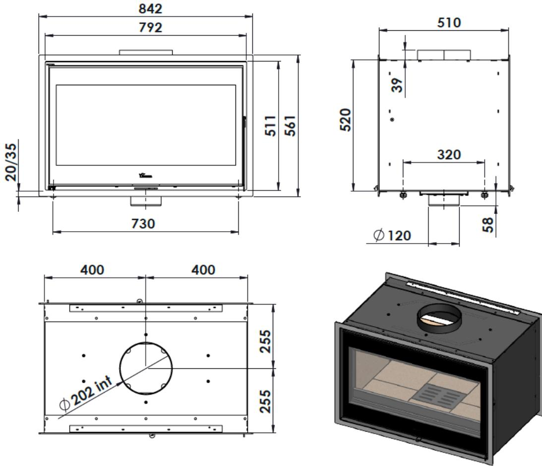
Figura nº2 - Dimensiones en mm del aparato Nickel 800 DC
