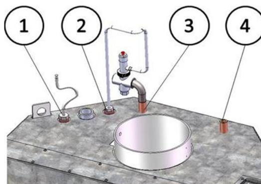
Figure n°17 - Raccordements débranchement dans le réservoir d'eau
