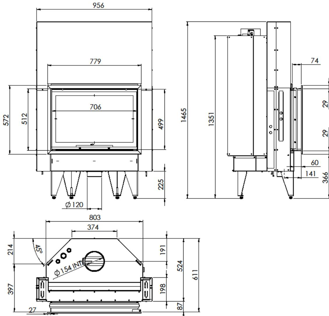
Figure n°1 - Dimensions en mm de l'appareil ITACA 80
