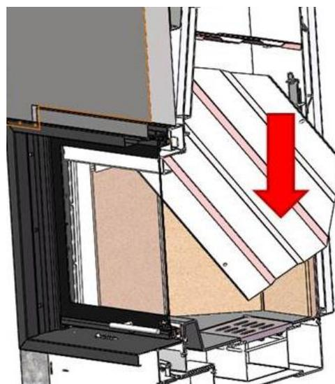
Figure n°23 - Démontage du déflecteur inférieur
