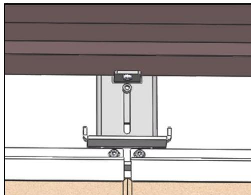
Figure n°22 - Posición 2 deflector inferior
