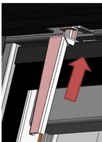
Figure n°28 - Introduisez l'outil de manipulation ouverture nettoyage vitre porte
