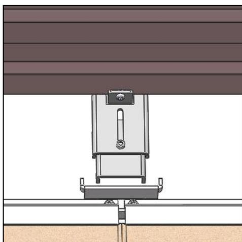
Figure n°21 - Position 1 du déflecteur inférieur
