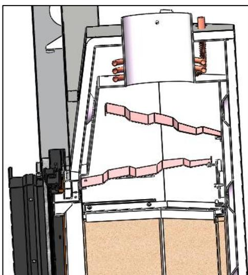
Figure n°20 - Vue de section avec les 2 déflecteurs placés
