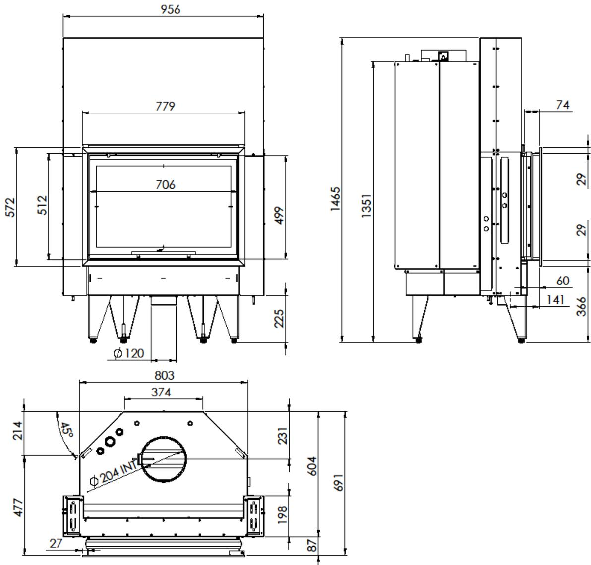
Figure n°2 - Dimensions en mm de l'appareil ITACA 80 Calefactora R18
