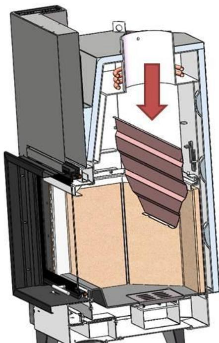
Figure n°24 - Démontage du déflecteur supérieur
