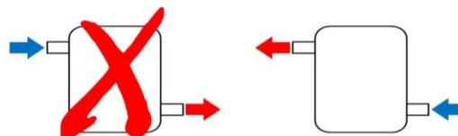
Figure n°15 - Branchement incorrect (gauche) et branchement correct (droite.)
