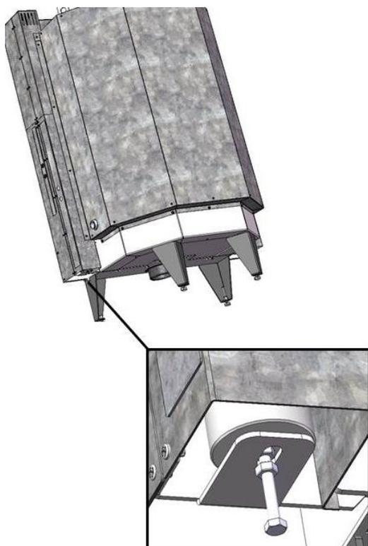
Figure n°4 - Accès pour dévisser les vis de fixation des contrepoids
