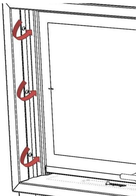
Figure n°10 - Dévissez les 6 vis qui fixent le cadre extérieur
