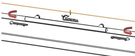
Figure n°9 - Dévissez les deux pivots des registres 1er et 2e
