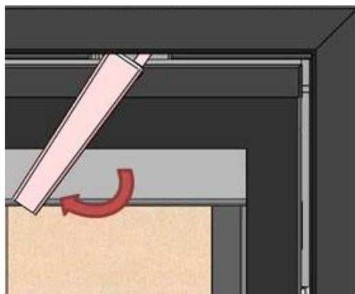
Figure n°30 - Tournez le pivot droit dans le sens des aiguilles d'une montre
