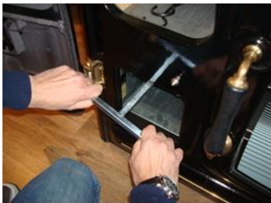
Figure n°17 - Mouvement pour monter ou descendre la position de la grille
