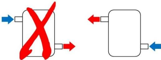
Figura nº9 - *Conexión incorrecta (izda) y conexión correcta (dcha)*
