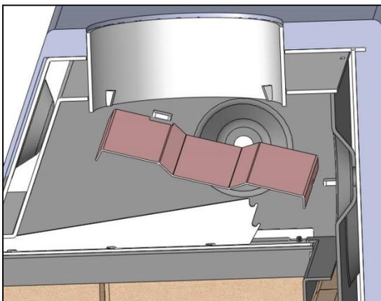
Figura nº15 - *Desmontaje deflectores, vista sección lateral*
