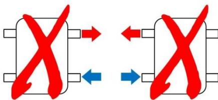
Figura nº10 - *Conexiones incorrectas (menor potencia térmica al agua)*
