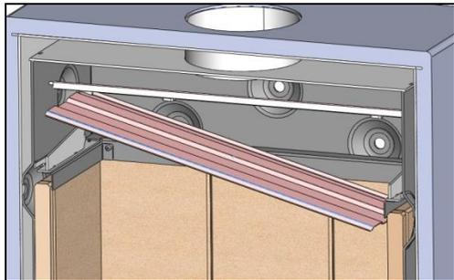
Figura nº14 - *Desmontaje deflectores, vista sección frontal*
