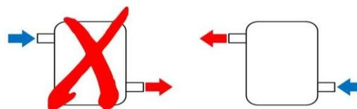
Figure n°16 - Branchement incorrect (gauche) et branchement correct (droite.)
