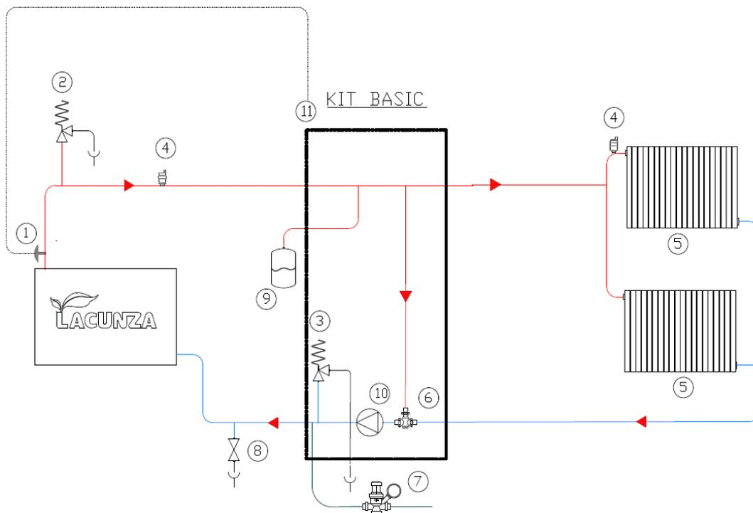
Lorsque l'eau du réservoir d'eau atteint 45° le thermostat (1) fera signe au régulateur automatique (11), et celui-ci fera fonctionner la pompe de circulation (10) jusqu'à ce que la température de l'eau descende en dessous de 43°.
