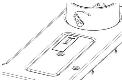
Figure n°8 - Sortie de fumée supérieure (avec clapet)
