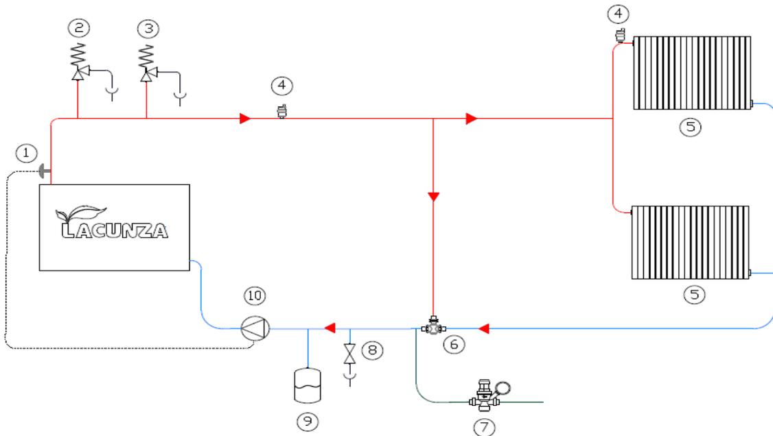
Lorsque l'eau du réservoir d'eau atteint 50° le thermostat (1) fera fonctionner la pompe de circulation (10), jusqu'à ce que la température de l'eau descende en dessous de cette valeur.
