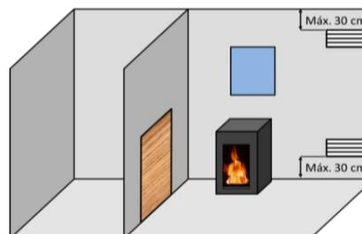
Figure n°4 - Schéma indicatif pour les grilles de ventilation
