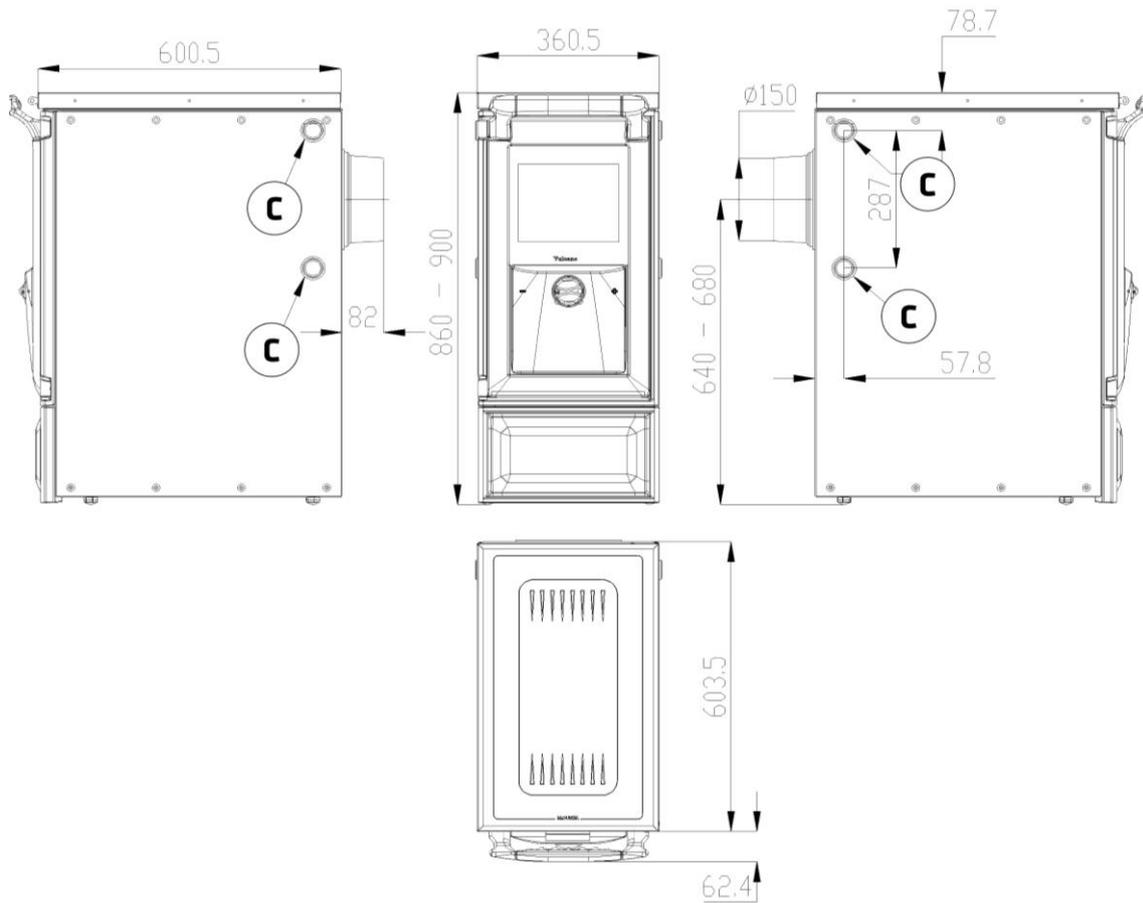
Figure n°1 - Dimensions en mm de l'appareil Vulcano 4T E
