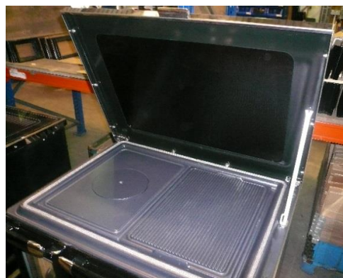
Figure n°28 - Protection sous la plaque vitrocéramique
