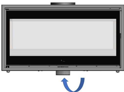
Figure n°11 - Conduite de l'air pour la chambre de combustion Verona 800-1000.
