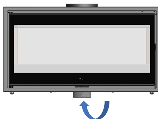
Figure n°6 - Conduite de l'air pour la chambre de combustion Verona 1000.
