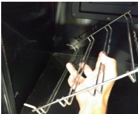
Figura nº22 - Retrait des supports des tiges
