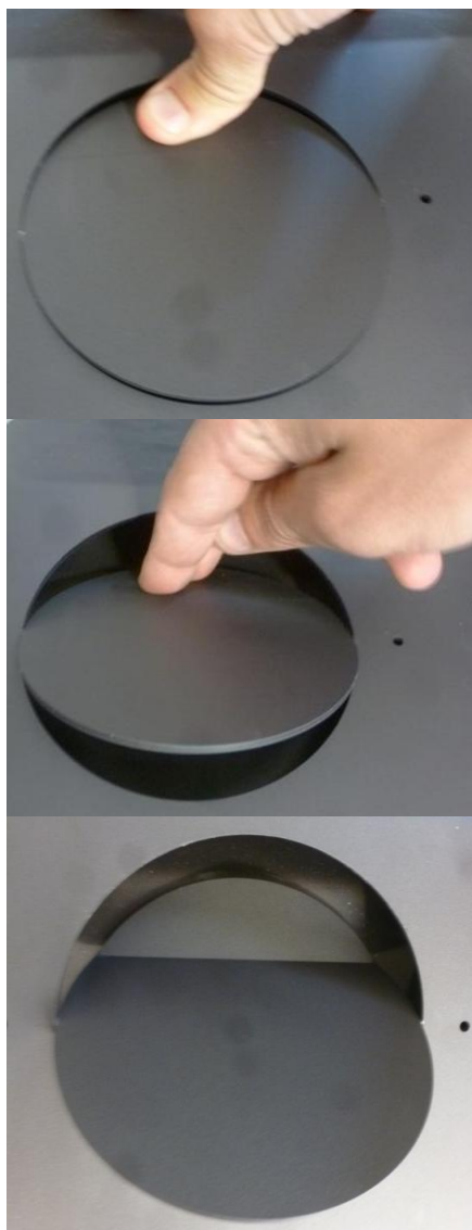
Figure n°6 - Séquence de la façon de tourner la demi-découpe circulaire
