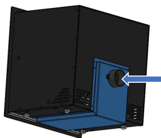
Figure n°4 - Accessoire pour canaliser l'entrée d'air par l'arrière
