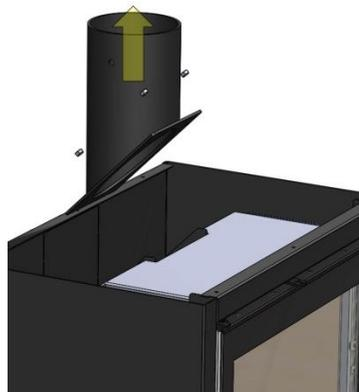
Figure n°6 - Dévisser la sortie des fumées
