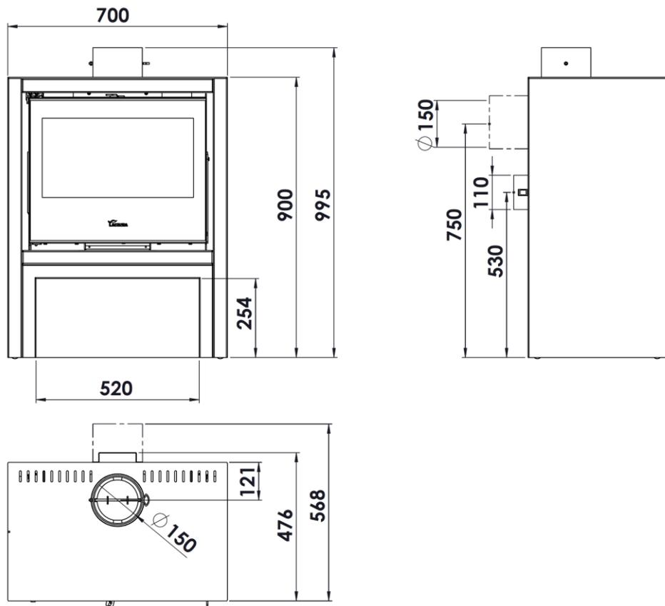
Figure n°1 - Dimensions en mm de l'appareil PLATINUM 600
