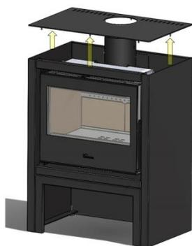
Figure n°5 - Soulever la taque (pas de vis)
