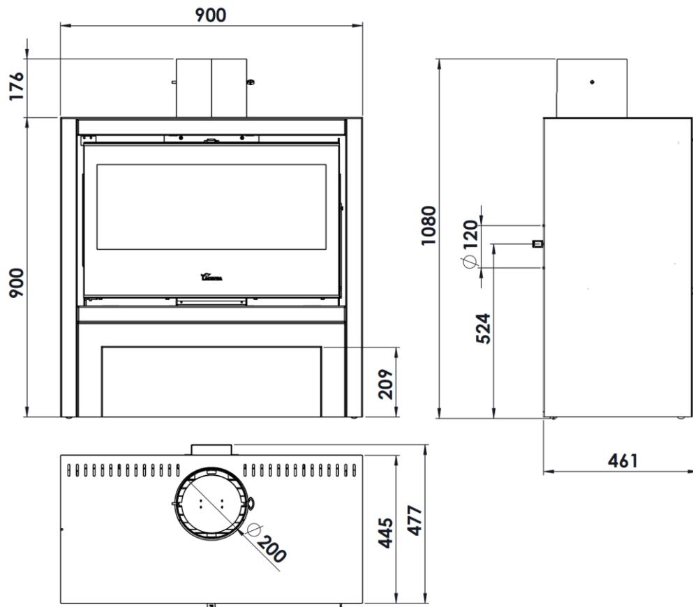
Figure n°2 - Dimensions en mm de l'appareil PLATINUM 800
