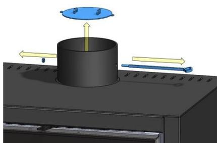
Figure n°4 - Démontez le clapet coupe tirage
