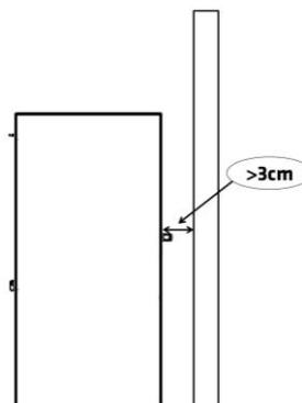
Figure n°12 - Distance entre l'appareil et le mur arrière
