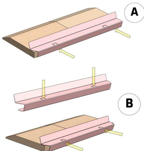
Figure n°20 - Différentes positions du déflecteur inférieur Platinum 600
