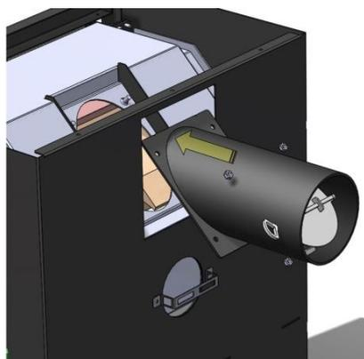
Figure n°9 - Remonter la sortie des fumées à l'arrière
