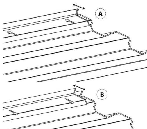
Figure n°18 - Différentes positions du déflecteur inférieur Platinum 800
