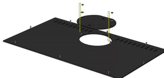
Figure n°10 - Monter sur la taque le tampon des fumées avec les écrous et rondelles fournis
