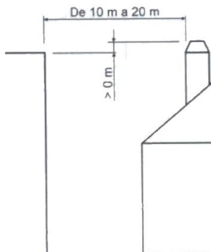
Figure n°15 - Distances entre le sommet et les objets entre 10 et 20m
