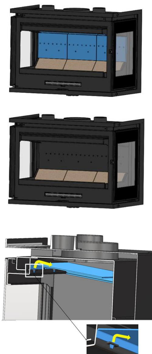
Figure n°23 - Démontage du déflecteur acier
