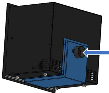
Figure n°8 - Accessoire pour canaliser l'entrée d'air par l'arrière
