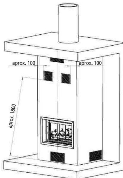
Figure n°4 - Schéma extérieur de la fermeture
