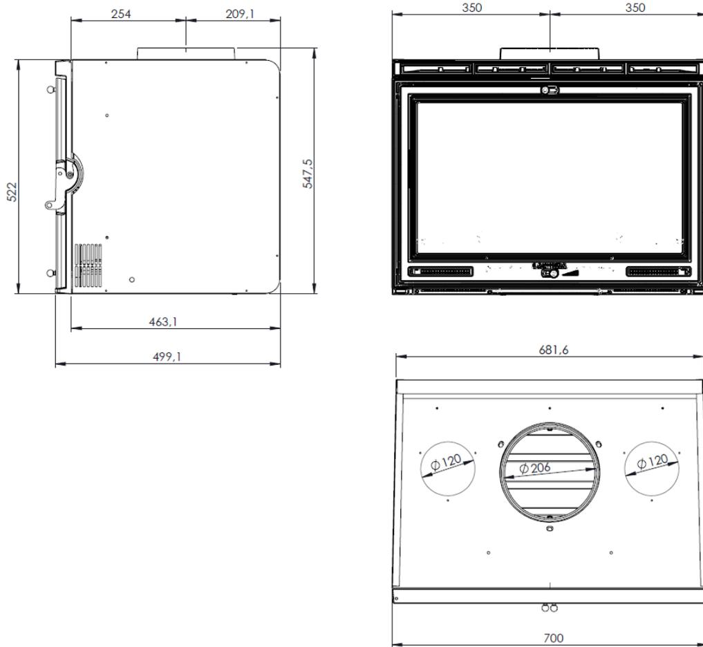
Figure n°1 - Dimensions en mm de l'appareil MIDI-700
