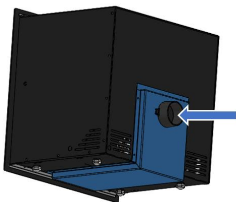
Figure n°8 - Accessoire pour canaliser l'entrée d'air par l'arrière
