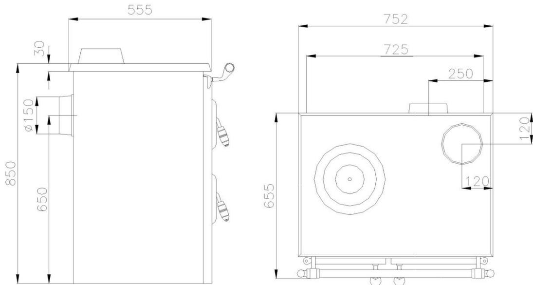
Figure n°1 - Dimensions en mm de l'appareil Lis 5T
