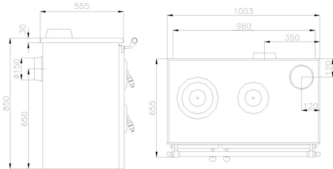
Figure n°3 - Dimensions en mm de l'appareil Lis 7T
