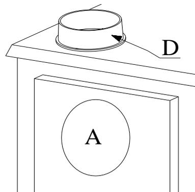
Figure n°6 - Schéma pour sortie de fumée supérieure
