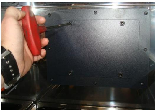
Figure n°15 - Accès pour le nettoyage de la sortie de fumée
