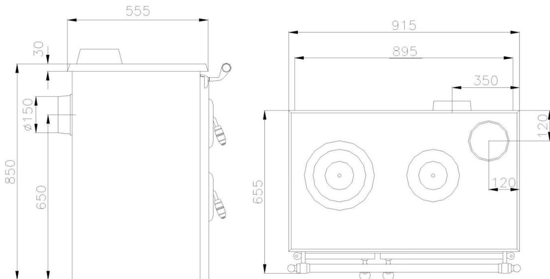
Figure n°2 - Dimensions en mm de l'appareil Lis 7T
