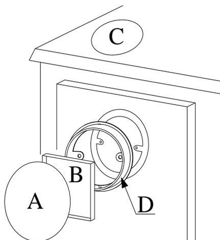
Figure n°5 - Schéma pour sortie de fumée arrière
