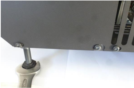
Figure n°4 - Détail de la clé fixe 24 pour régler les pieds
