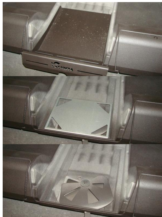
Figure n°25 - Séquence de démontage de pièces pour accéder au nettoyage
