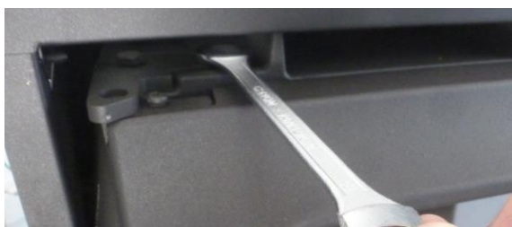
Figure n°10 - Relâcher le support de la porte avec clé plate de 10
