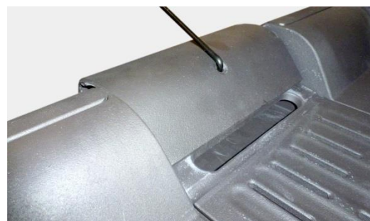
Figure n°22 - Séparateur mû dans la position de petite trappe ouverte.
