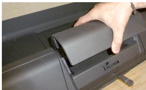
Figure n°23 - On retire le séparateur
