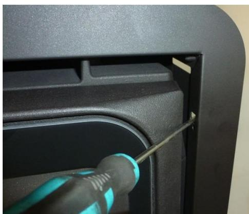
Figure n°12 - Manière de plier les languettes
