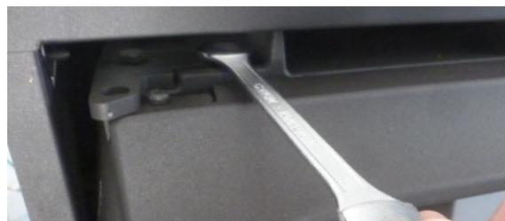
Figure n°9 - Relâcher le support de la porte avec clé plate de 10
