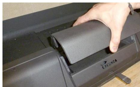
Figure n°22 - On retire le séparateur
