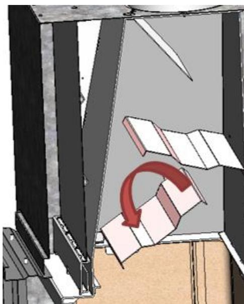
Figure n°28 - Démontage du déflecteur supérieur Itaca 80
