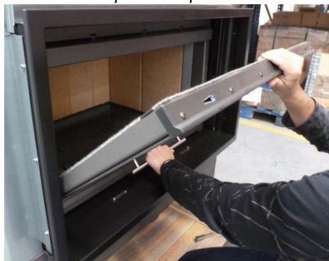
Figure n°42 - Étape intermédiaire en rabattant la porte
