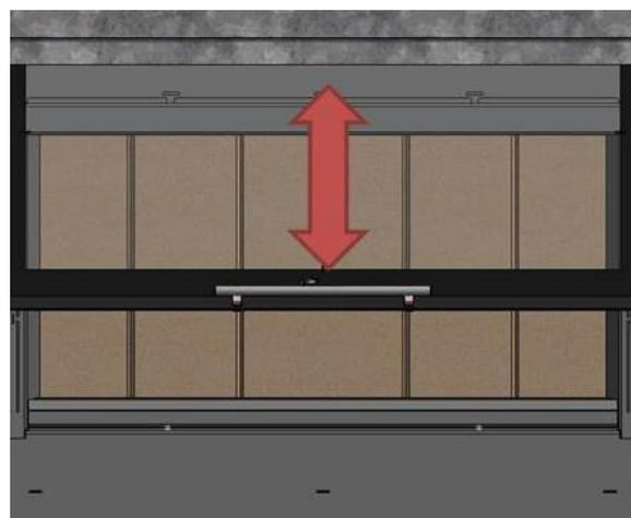
Figure n°36 - Ouverture guillotine
