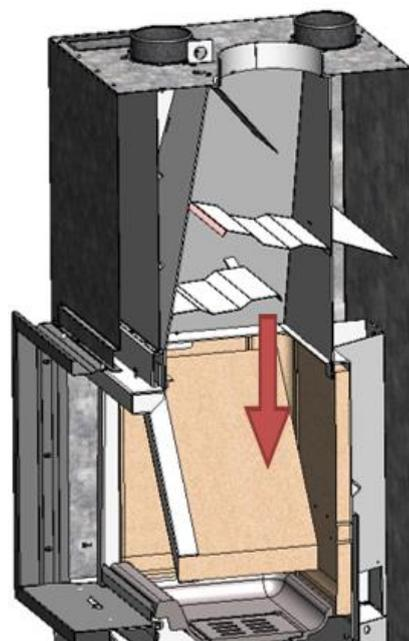
Figure n°31 - Démontage du déflecteur inférieur Itaca 80 eco
