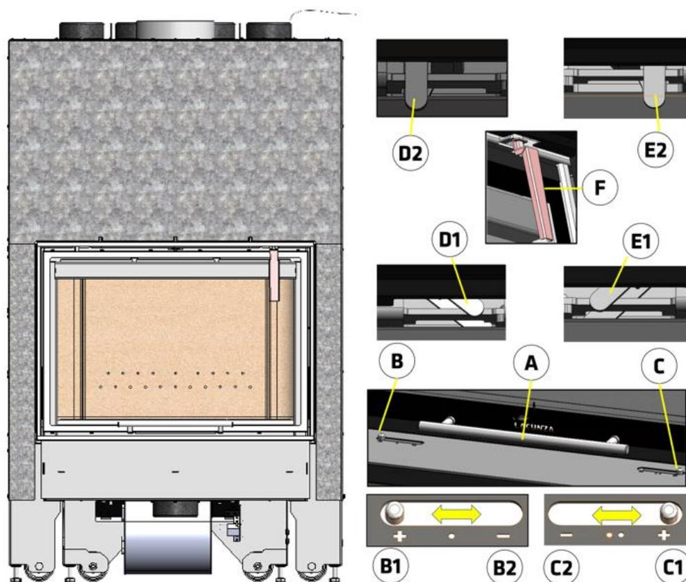
Figure n°26 - Éléments de fonctionnement de l'appareil
