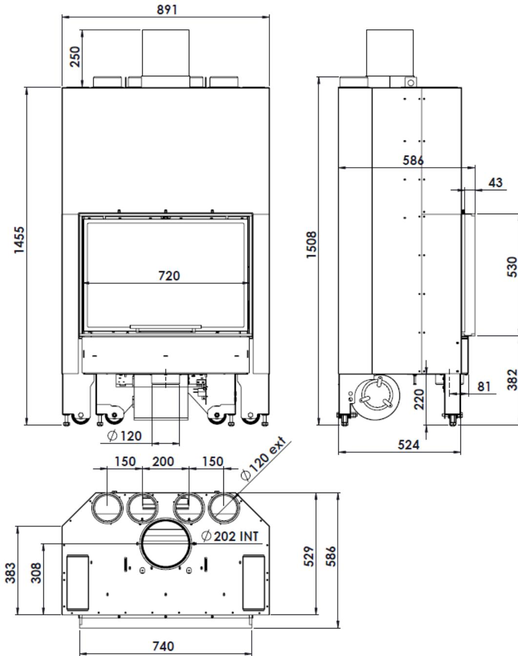
Figure n°1 - Dimensions en mm de l'appareil ITACA 80 eco
