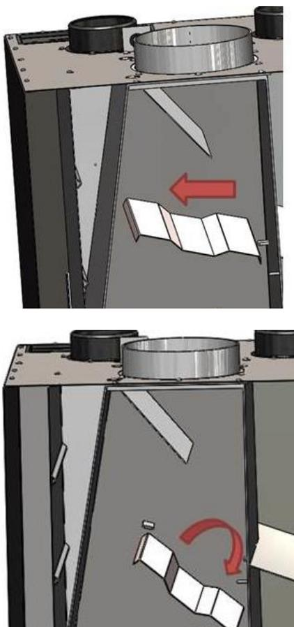
Figure n°33 - Démontage du déflecteur supérieur Itaca 80
