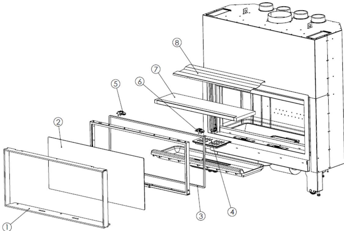
Figure n°51 - Pièces détachées Itaca 100 et 120 eco
