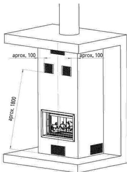
Figure n°7 - Schéma extérieur de la fermeture
