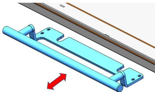
Figure n°45 - Extraction de vis et utilisation comme poignée froide
