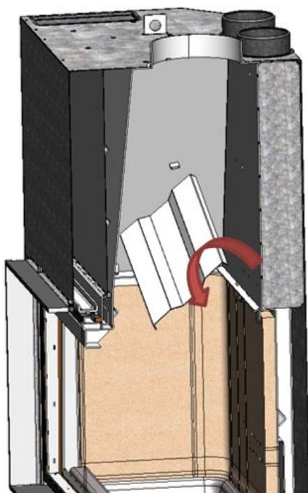
Figure n°35 - Démontage du déflecteur supérieur Itaca 100 y 120 eco
