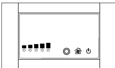
Figure n°46 - Display du régulateur d'air automatique / manuel Itaca eco
