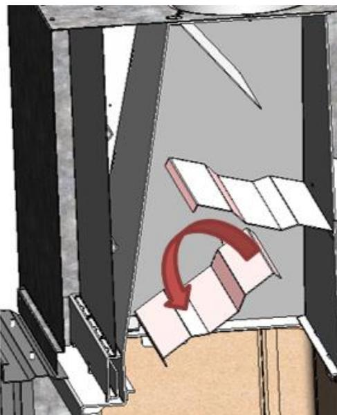
Figure n°32 - Démontage du déflecteur supérieur Itaca 80
