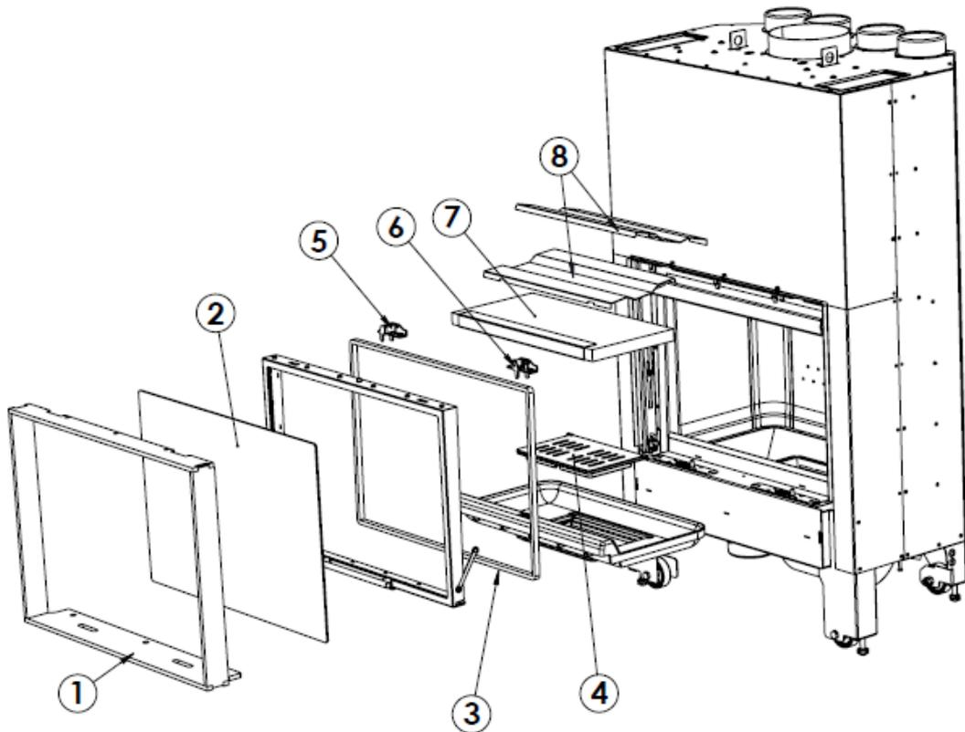
Figure n°50 - Pièces détachées Itaca 80 eco
