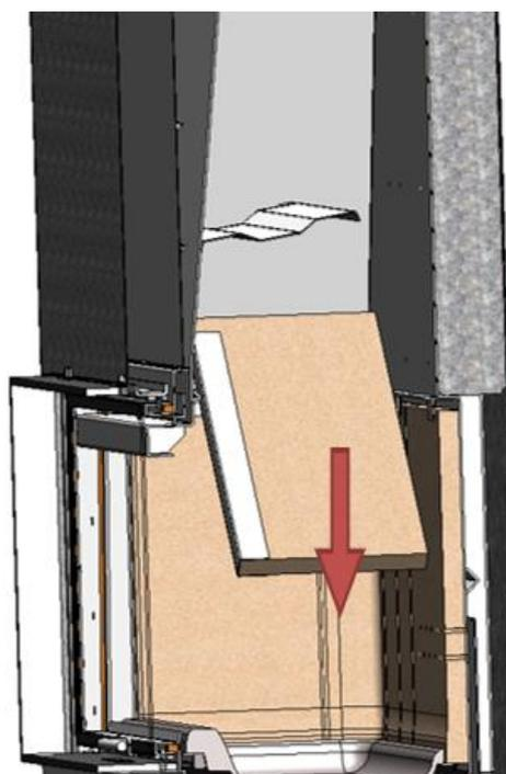
Figure n°34 - Démontage du déflecteur inférieur Itaca 100 et 120 eco
