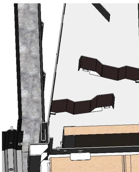
Figure n°29 - Vue de section avec les déflecteurs placés
