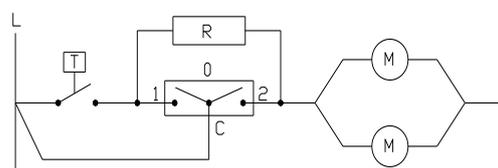
Figure n°15 - Schéma électrique des ventilateurs
