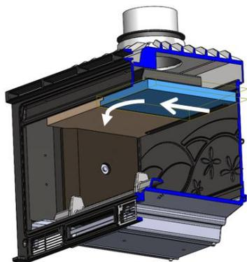
Figure n°13 - Déplacez-vous vers l'avant et inclinez une moitié du déflecteur en vermiculite pour le retirer
