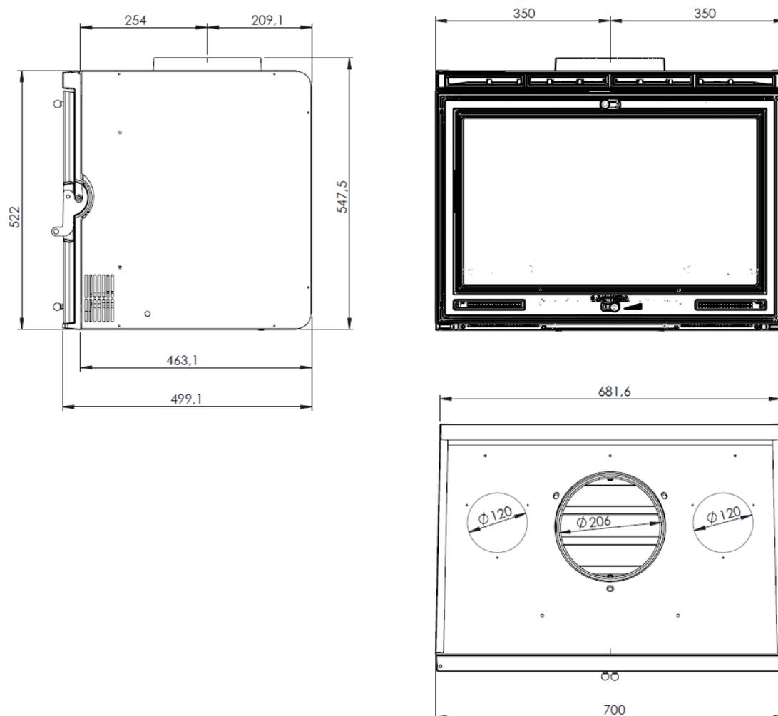
Figure n°1 - Dimensions en mm de l'appareil IN-700/INDIA
