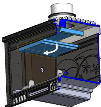
Figure n°14 - Retirez l'autre moitié du déflecteur en vermiculite et le déflecteur en acier en même temps
