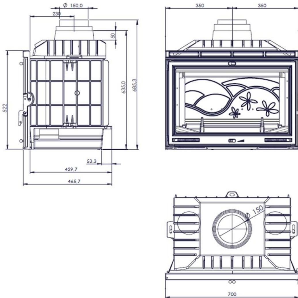
Figure n°2 - Dimensions en mm de l'appareil RE-700/NEPAL
