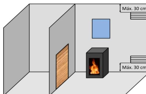
Figure n°3 - Schéma indicatif pour les grilles de ventilation
