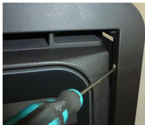
Figure n°12 - Manière de plier les languettes
