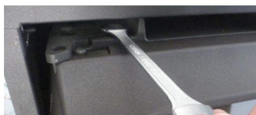
Figure n°9 - Relâcher le support de la porte avec clé plate de 10
