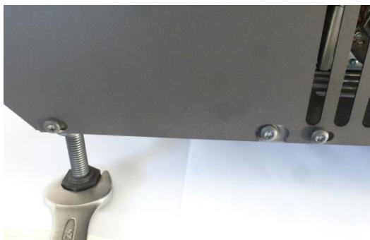
Figure n°4 - Détail de la clé fixe 24 pour régler les pieds
