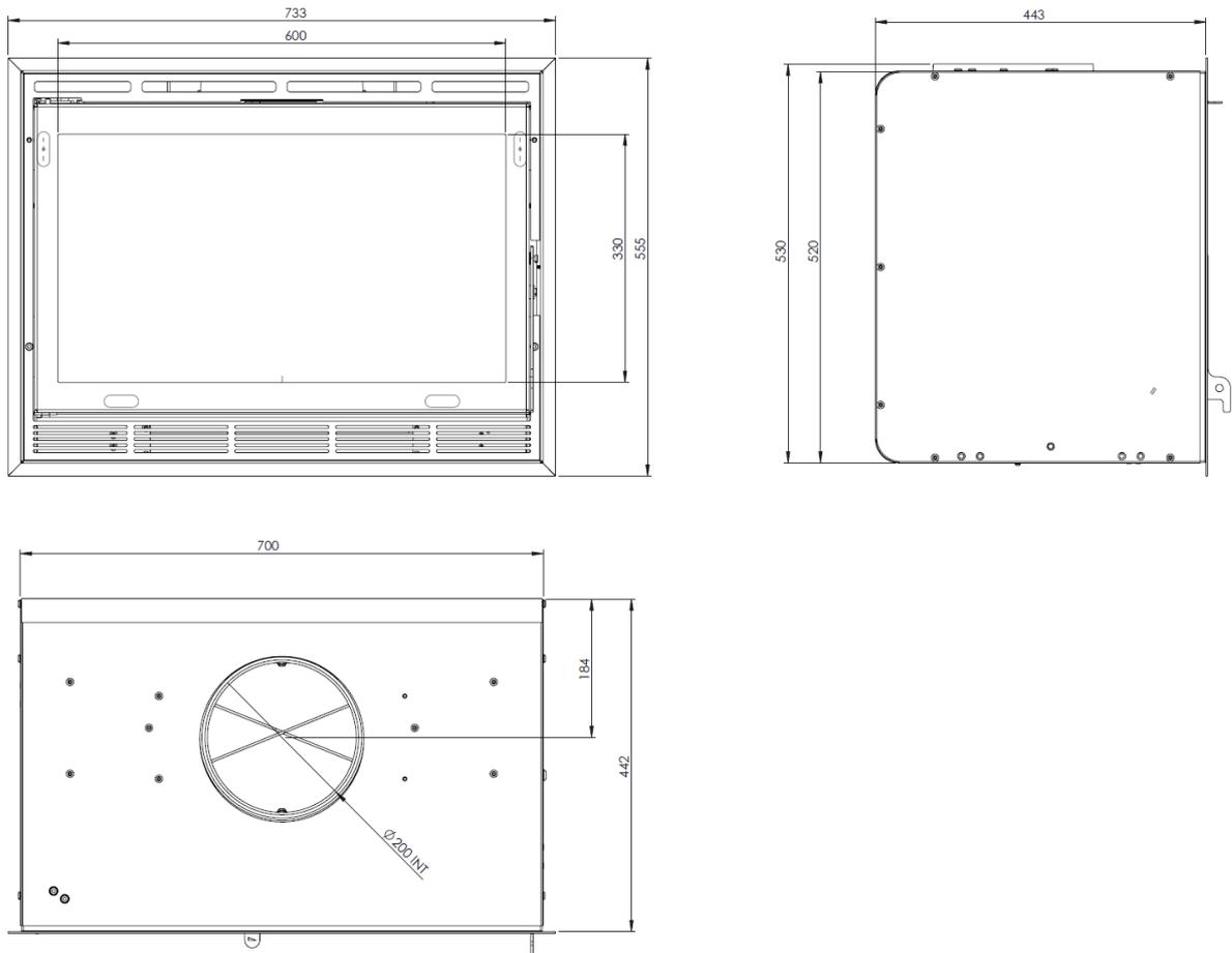
Figure n°1 - Dimensions en mm de l'appareil IC-700 AROA-700
