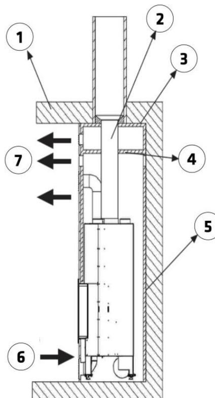
Figure n°6 - Schéma intérieur de la fermeture
