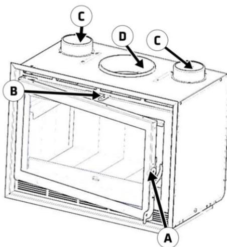
Figure n°12 - Éléments de fonctionnement de l'appareil
