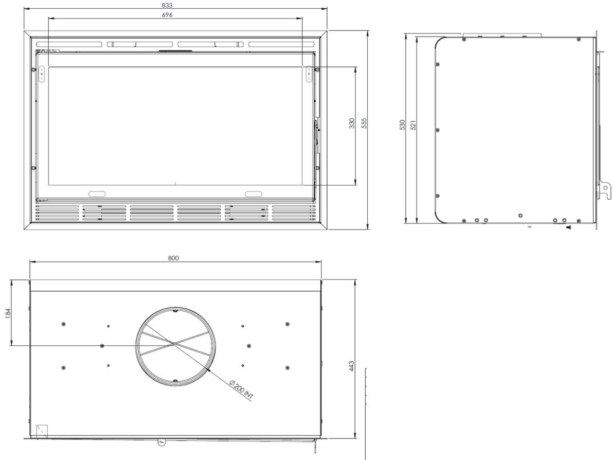
Figure n°2 - Dimensions en mm de l'appareil IC-800 AROA-800
