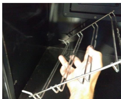
Figura n°22 - Retrait des supports des tiges
