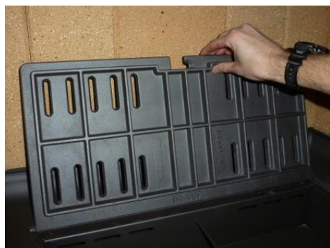
Figure n°18 - Posez la grille au fond du foyer
