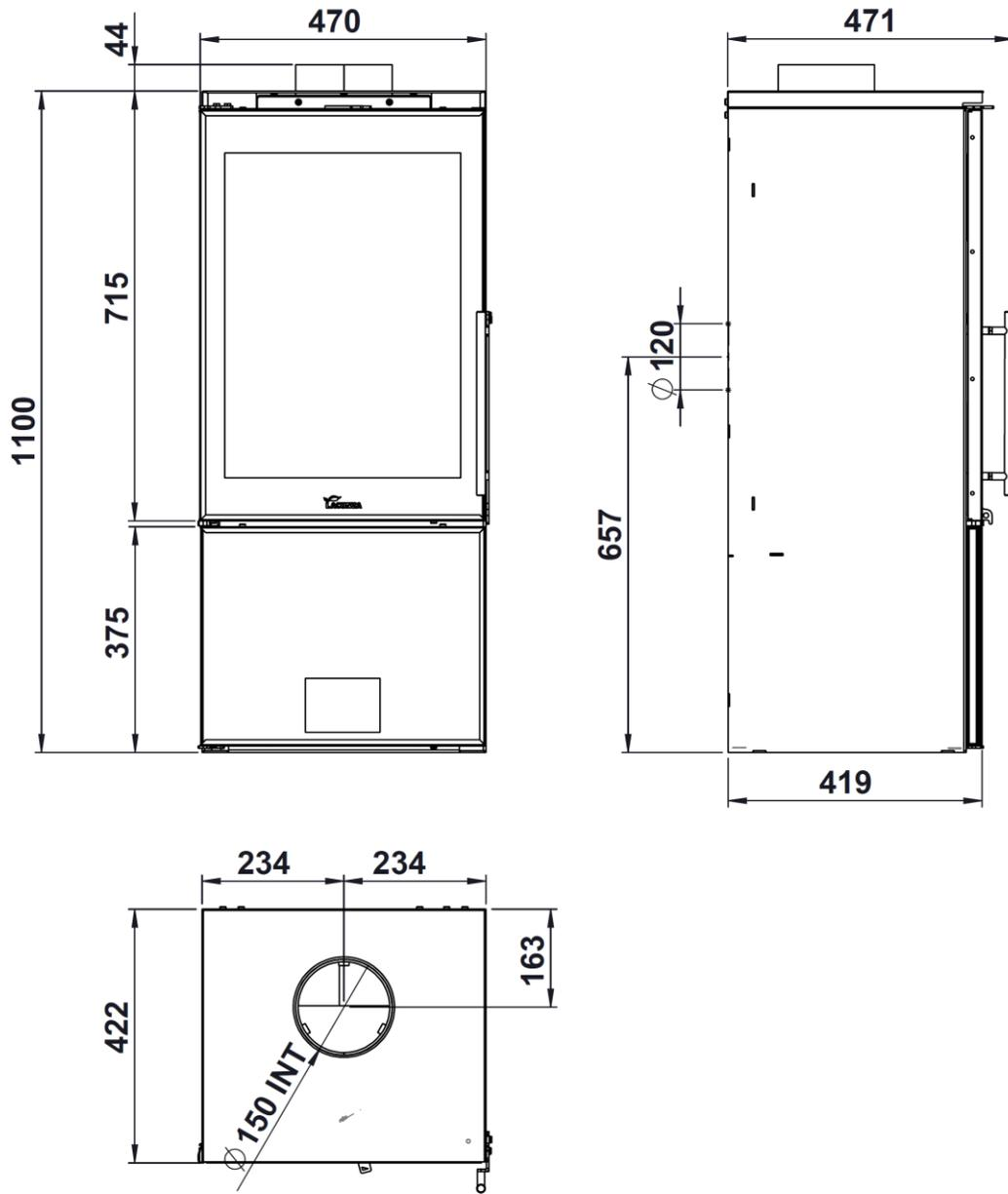
Figure n°1 - Dimensions en mm de l'appareil Dover / Calais
