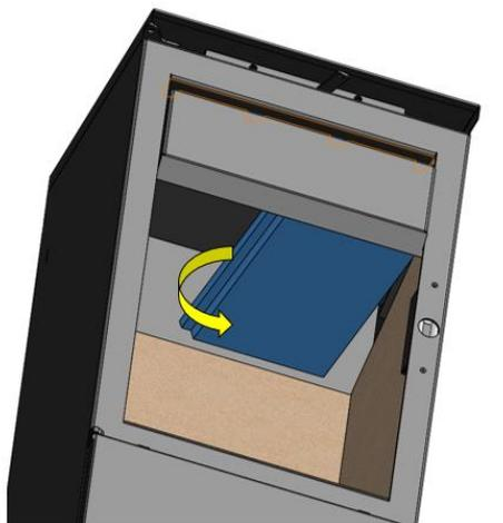
Figure n°7 - Extraction des déflecteurs en vermiculite
