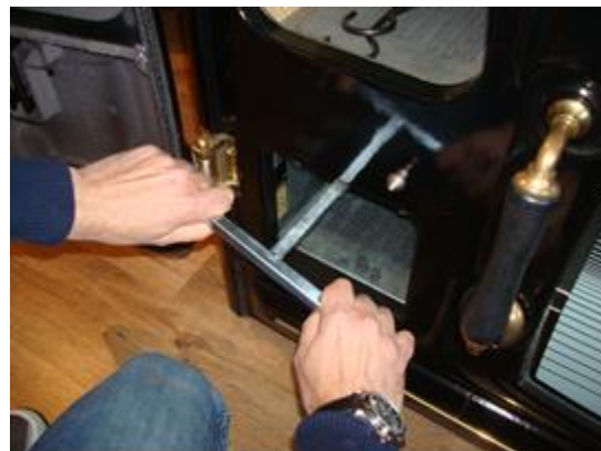
Figure n°15 - Mouvement pour monter ou descendre la position de la grille
