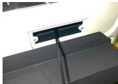
Figure n°20 - Accès pour le nettoyage de la sortie de fumée
