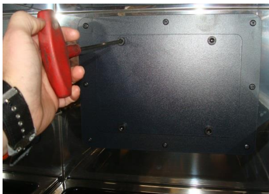
Figure n°19 - Accès pour le nettoyage de la sortie de fumée
