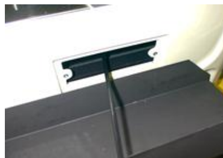
Figure n°18 - Accès pour le nettoyage de la sortie de fumée
