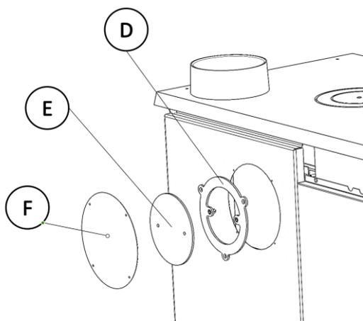
Figure n°8 - Nous plaçons l'adaptateur et les couvercles
