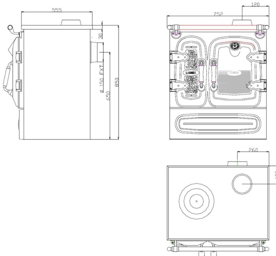
Figure n°1 - Dimensions en mm de l'appareil Clásica 5T
