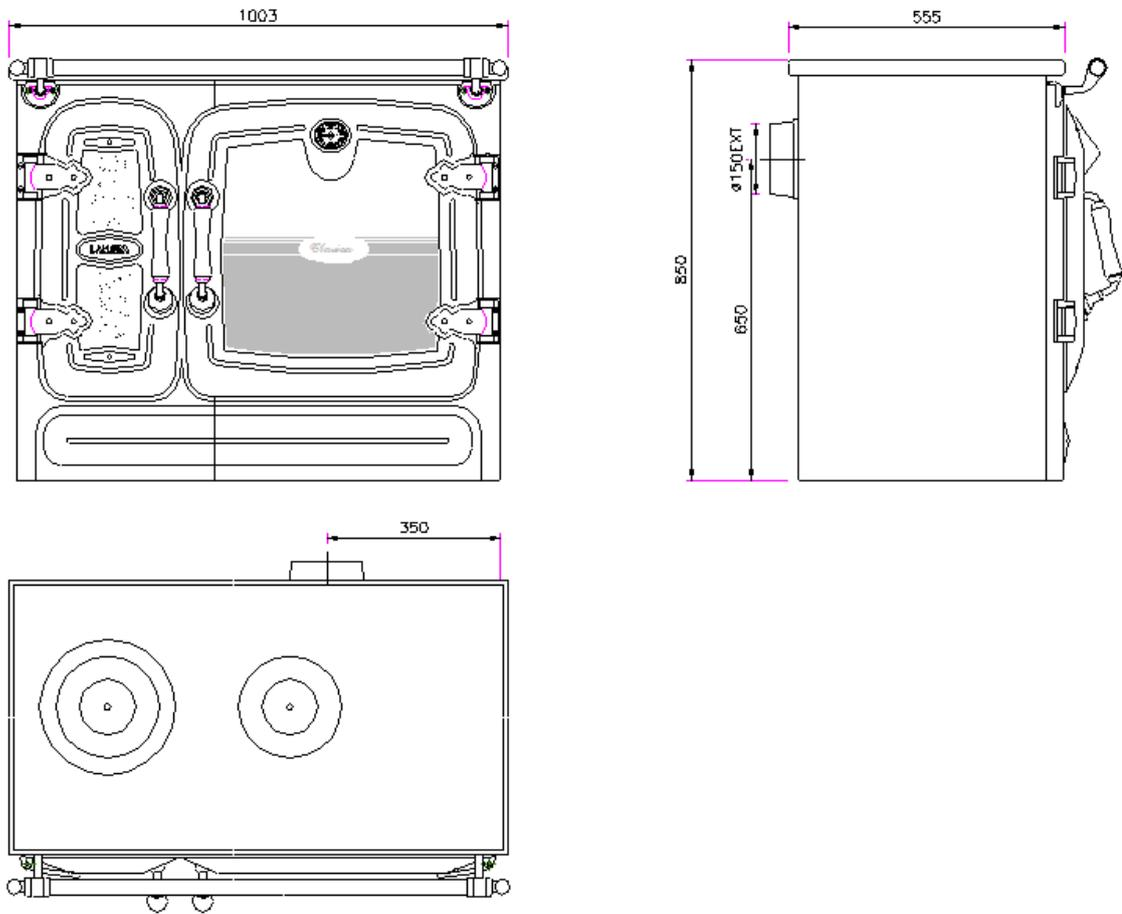
Figure nº3 - Dimensions en mm de l'appareil Clásica 8T
