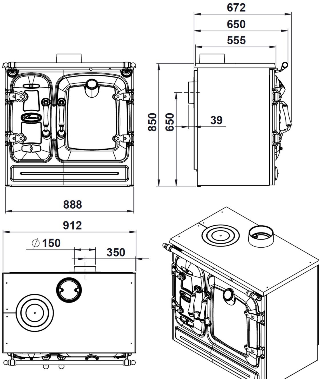
Figure n°2 - Dimensions en mm de l'appareil Clásica 7T
