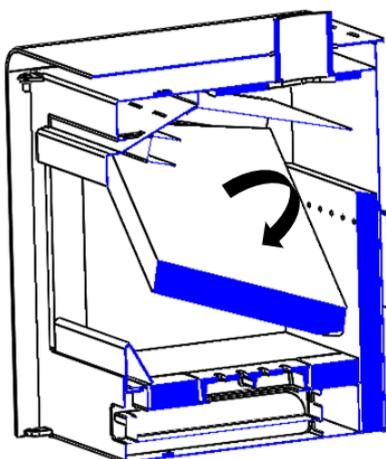
Figure n°12 - Extraction des déflecteurs en vermiculite
