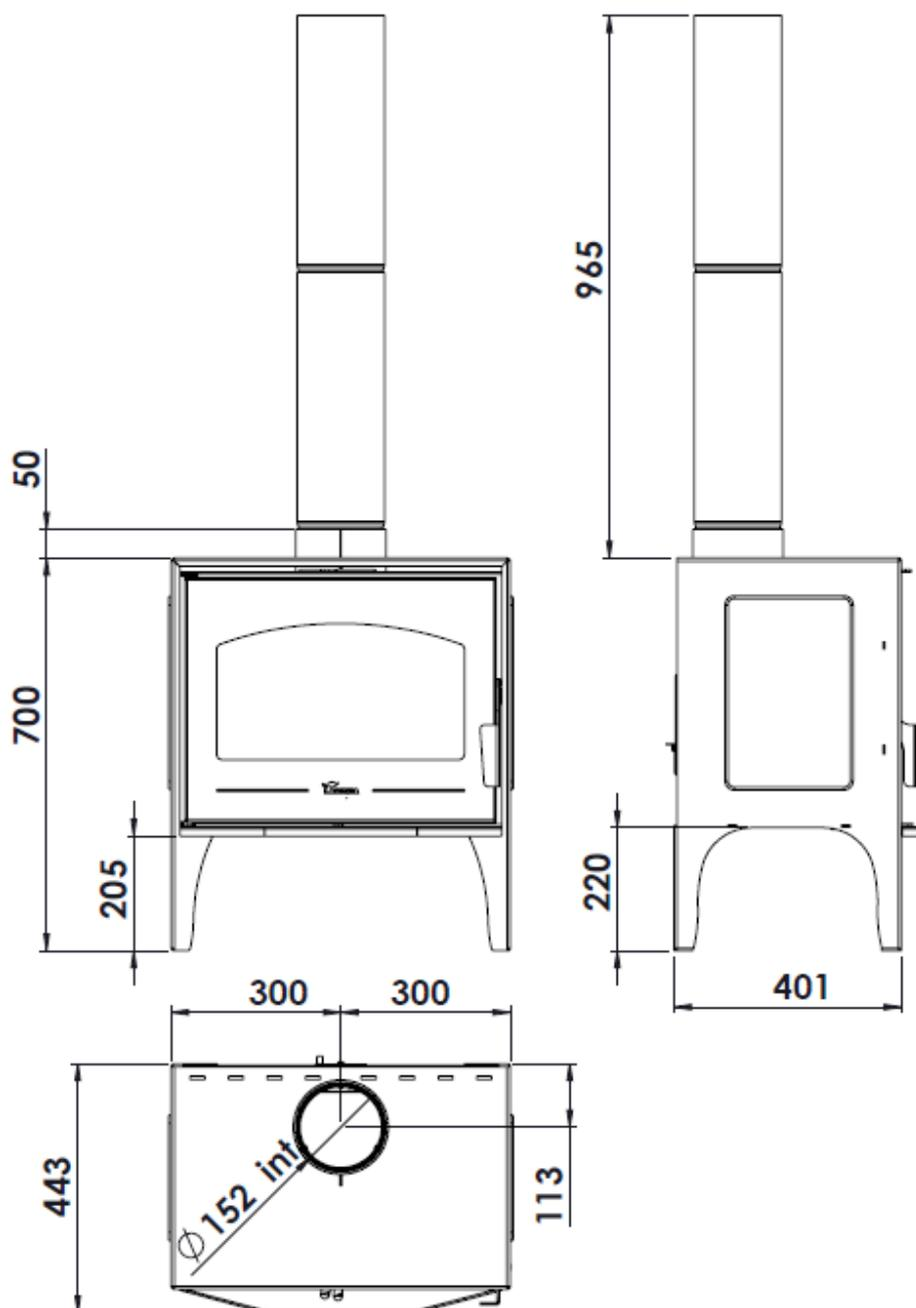
Figure n°1 - Dimensions en mm de l'appareil CALPE
