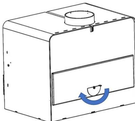
Figure n°10 - Registre d'arrivée d'air de double combustion fermé
