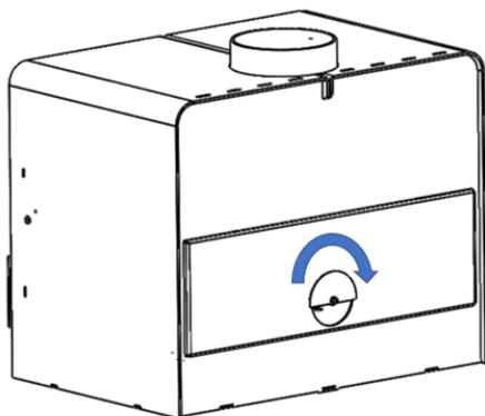
Figure n°9 - Registre d'arrivée d'air de double combustion ouvert
