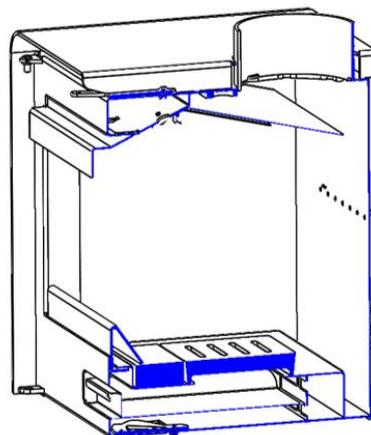
Figure n°13 - Extrayez le reste des vermiculites
