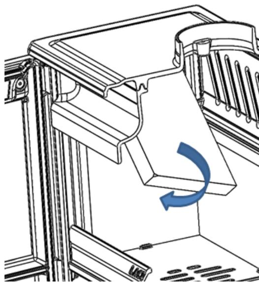
Figure n°13 - Extraction des déflecteurs en vermiculite
