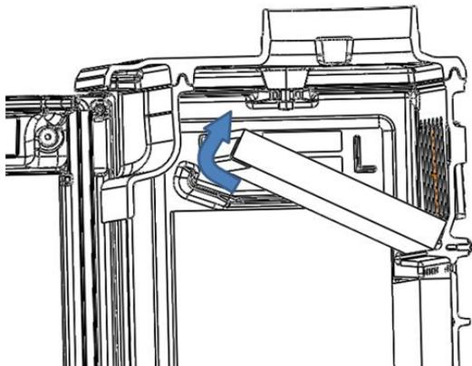
Figure n°11 - Rotation du renfort en acier inoxydable
