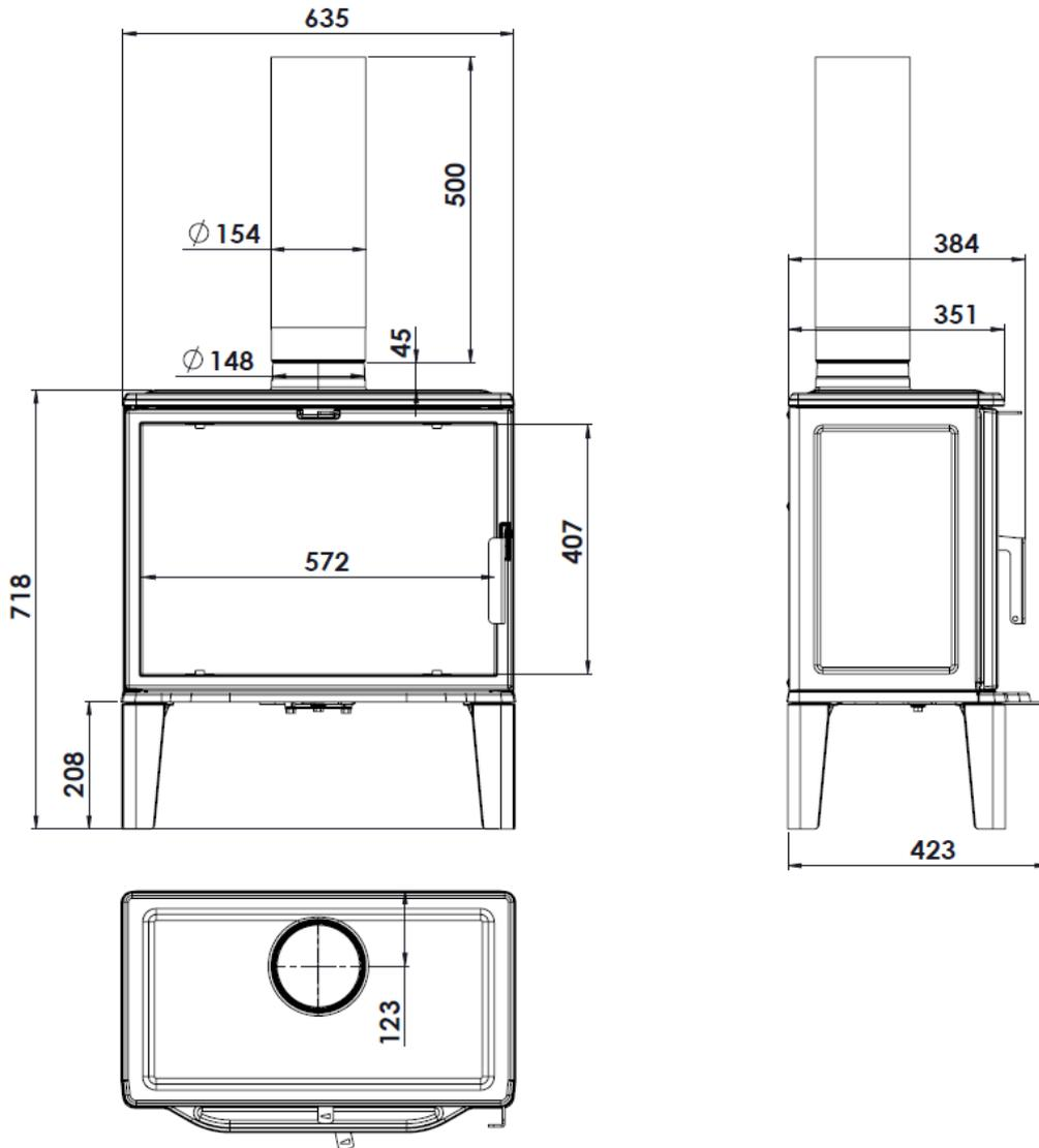
Figure n°1 - Dimensions en mm de l'appareil Biarritz
