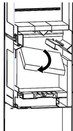
*Figure n°17 - Extraction des déflecteurs en vermiculite*
