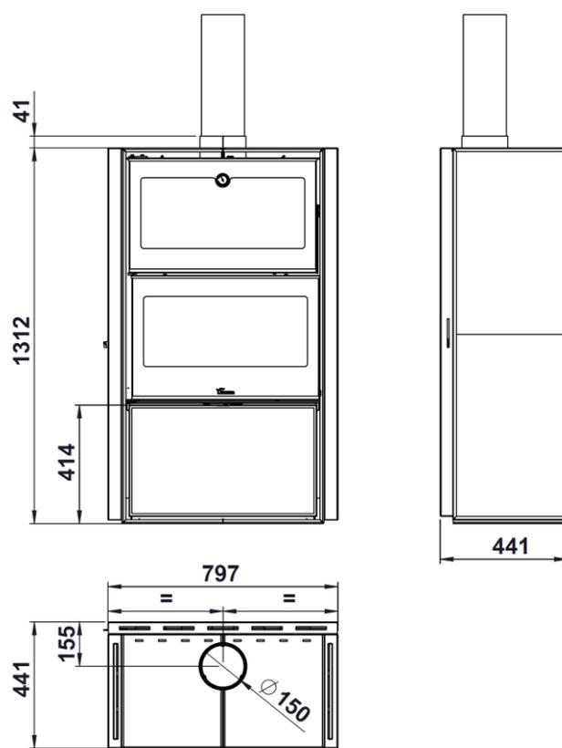
Figure n°1 - Dimensions en mm de l'appareil BERGEN
