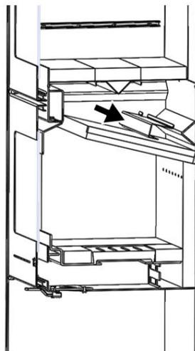
*Figure n°16 - Renfort sur les déflecteurs en vermiculite*
