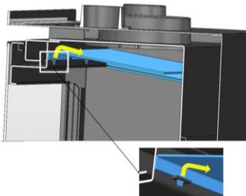
Figure n°9 - Démontage du déflecteur acier
