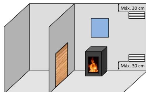
Figure n°6 - Schéma indicatif pour les grilles de ventilation
