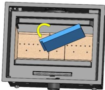
Figure n°8 - Démontage du vermiculite déflecteur plus bas
