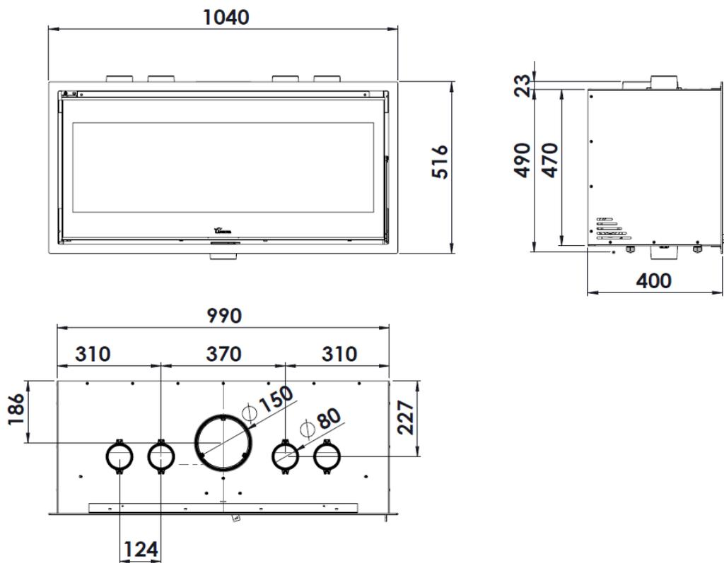
Figure n°5 - Dimensions en mm de l'appareil ADOUR 1000
