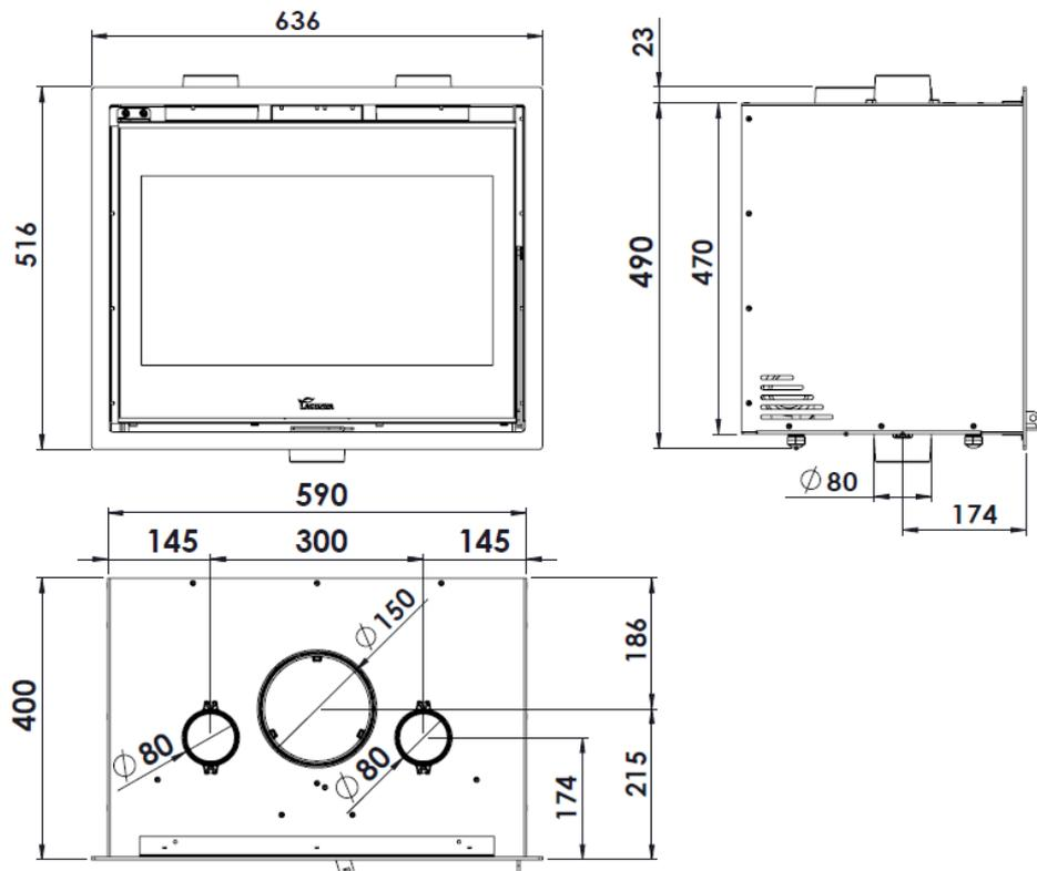
Figure n°2 - Dimensions en mm de l'appareil ADOUR 600
