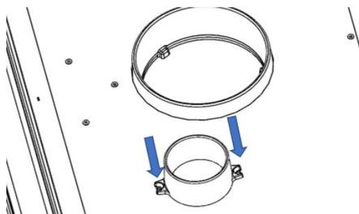
Figure n°15 - Vissez la tuyère sur la partie arrière
