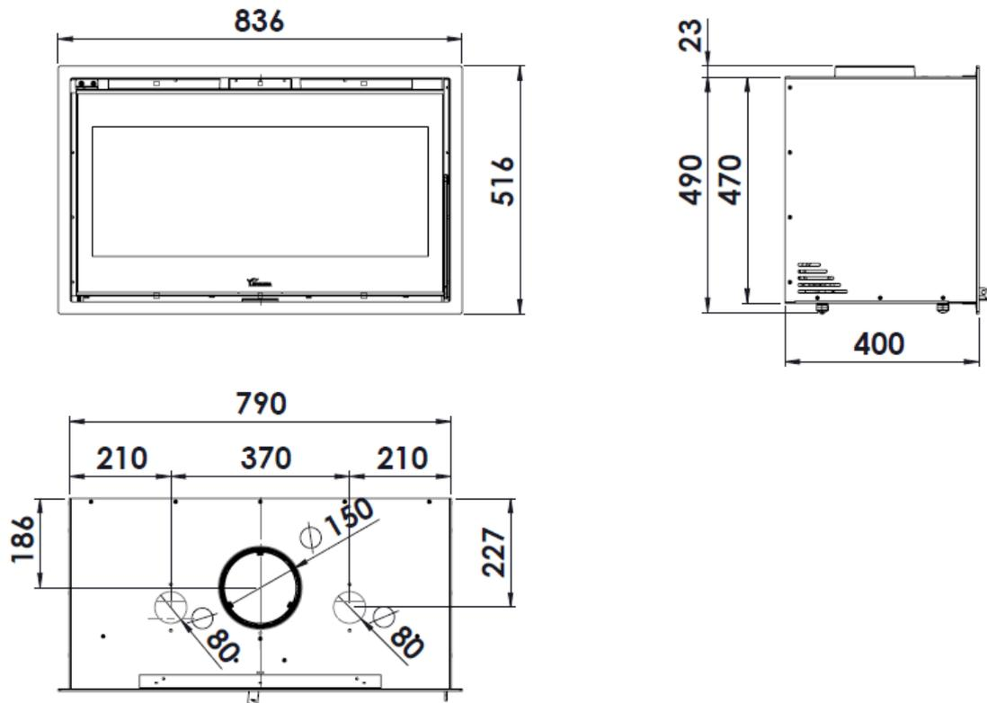
Figure n°4 - Dimensions en mm de l'appareil ADOUR 800
