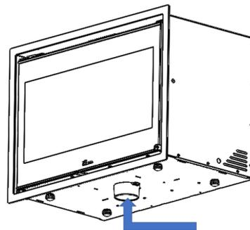
Figure n°9 - Conduction d'air pour la chambre de combustion
