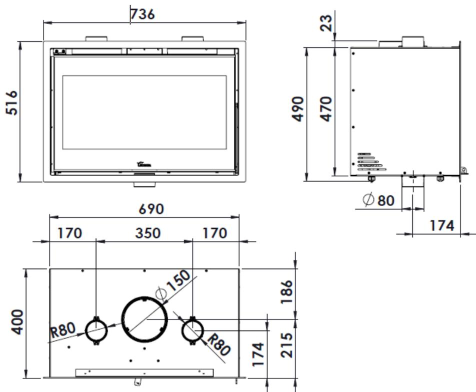
Figure n°3 - Dimensions en mm de l'appareil ADOUR 700
