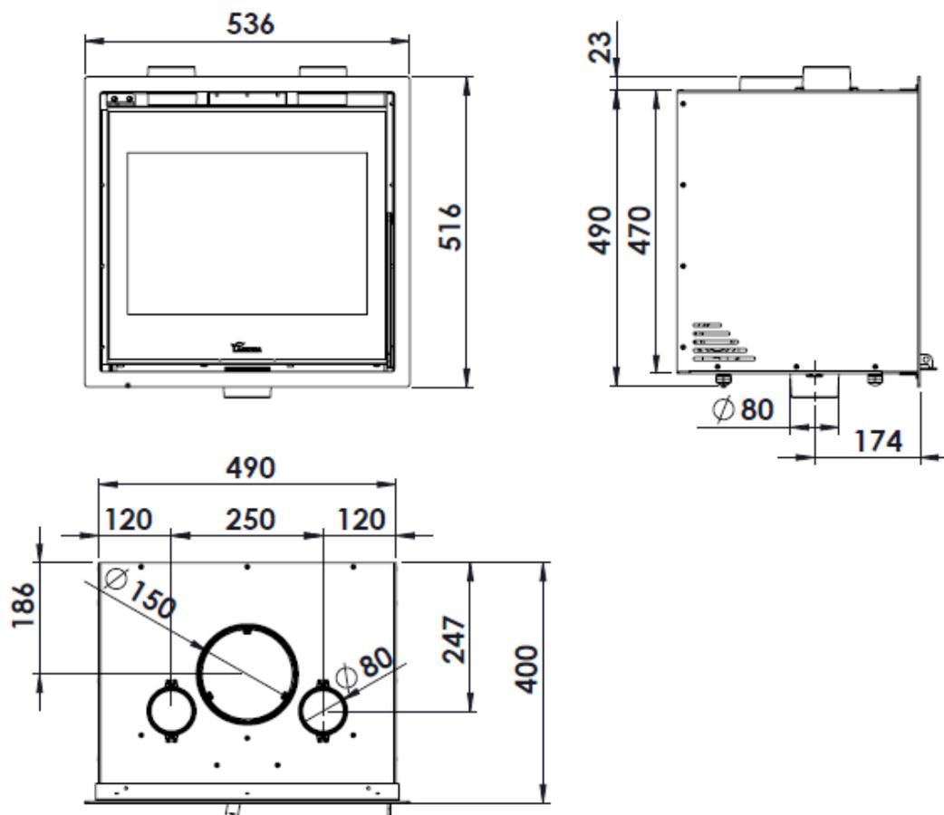
Figure n°1 - Dimensions en mm de l'appareil ADOUR 500
