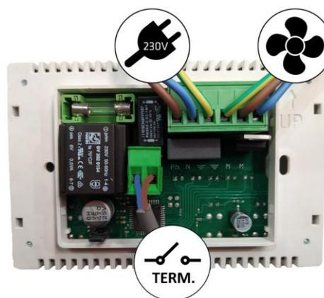
Figure n°1 - Connexions à réaliser au potentiomètre
