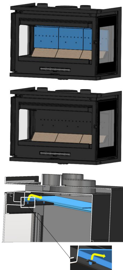
Figure n°9 - Démontage du déflecteur acier
