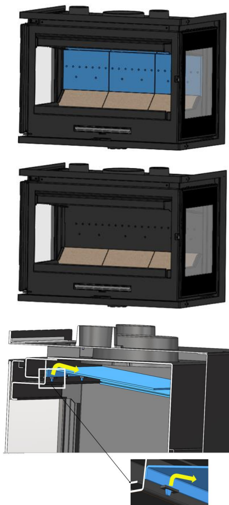
Figure n°9 - Démontage du déflecteur acier
