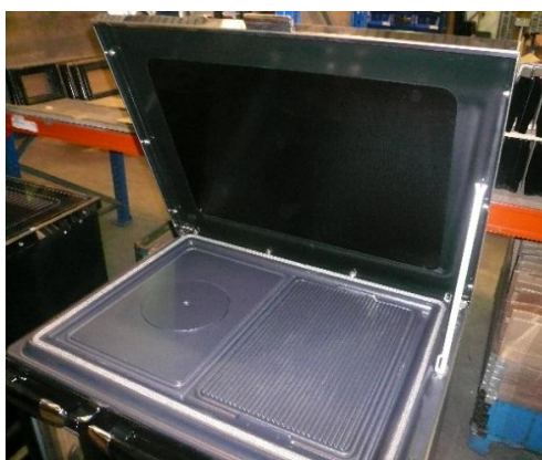
Figura n°26 - Protezioni sotto al piano cottura in vetroceramica
