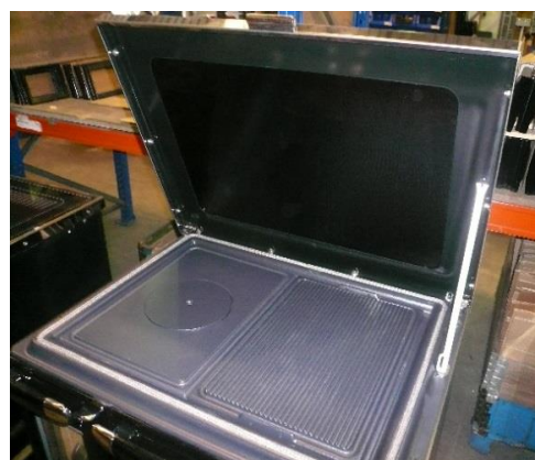
Figura n°28 - Protezioni sotto al piano cottura in vetroceramica
