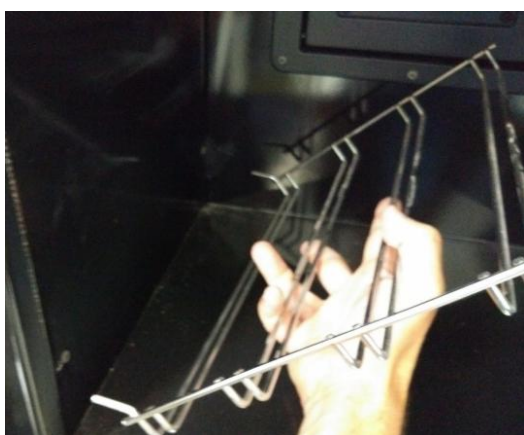
Figura n°22 - Estrazione delle barre di supporto.
