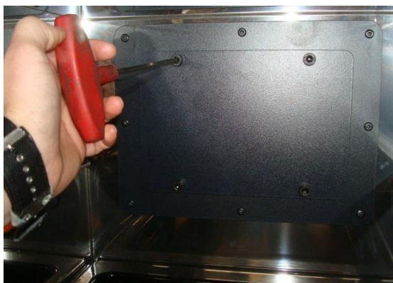
Figura n°20 - Accesso alle viti per rimuovere la copertura del sportello
