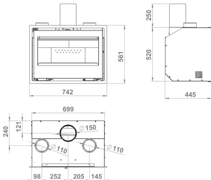
Figura n°1 - Dimensioni in mm dell'apparecchio SILVER 700 PLUS
