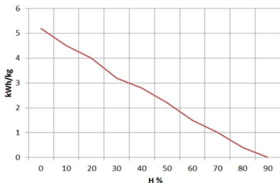
Figura n°16 - Rapporto tra umidità e potere calorifico della legna.
