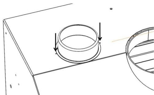
Figura n°9 - Avvitare la bocchetta nella parte posteriore
