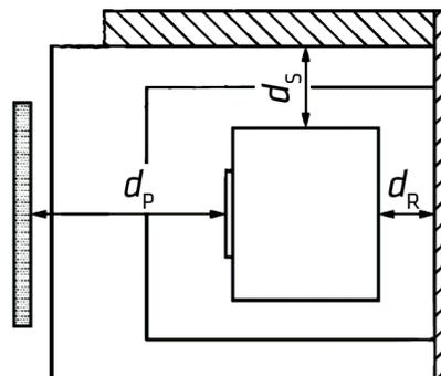
Se si tratta di un apparecchio da inserto, le distanze si misurano dalla parte esterna della parete ignifuga.
