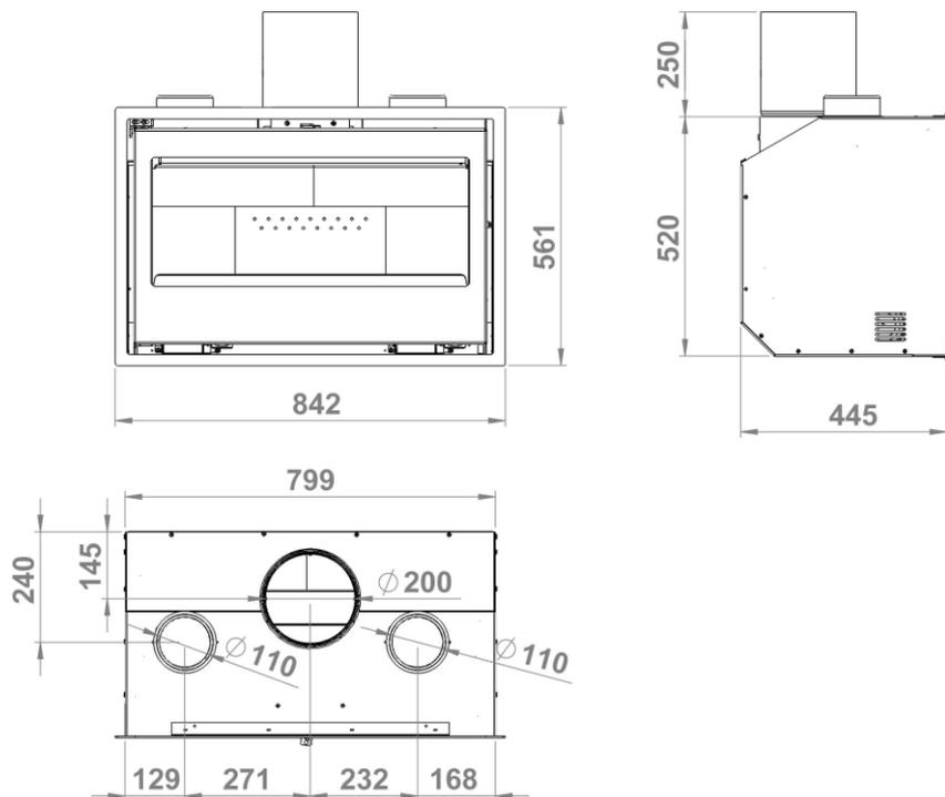
Figura n°2 - Dimensioni in mm dell'apparecchio SILVER 800 PLUS
