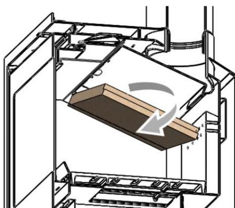
Figura n°2 - Estrazione dei deflettori in vermiculite
