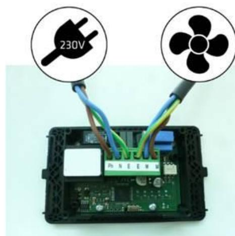
Figura n°12 - Collegamenti da realizzare nel potenziometro
