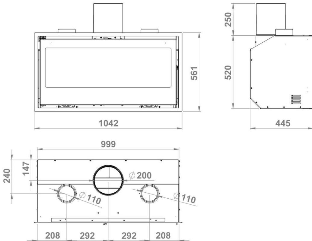
Figura n°3 - Dimensioni in mm dell'apparecchio SILVER 1000 PLUS
