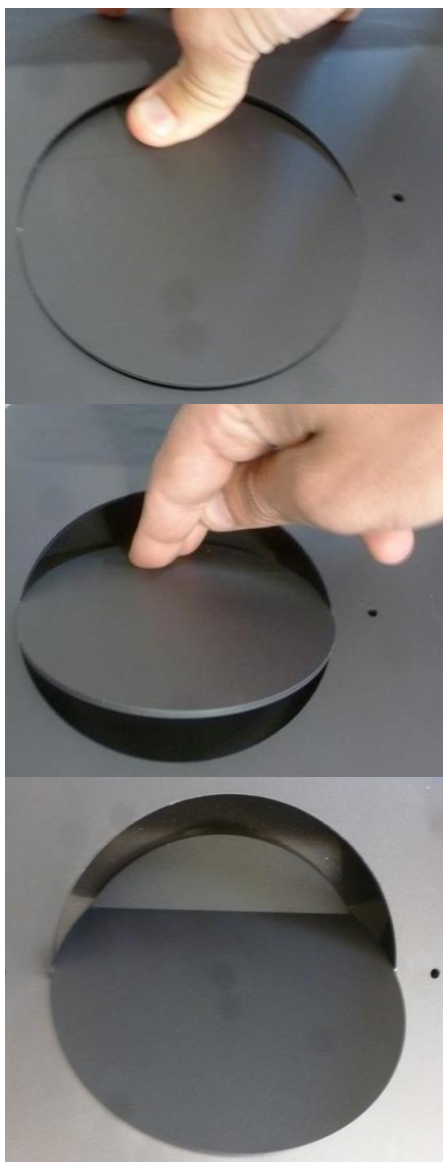
Figura n°6 - Sequenza di come ruotare la semisezione circolare
