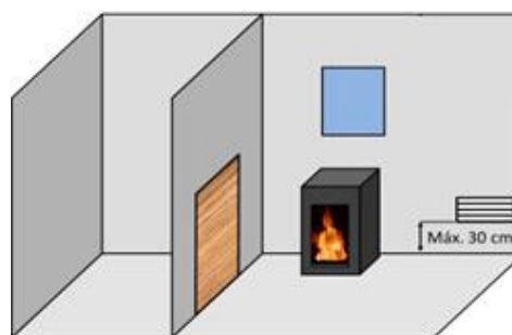
Figura n°2 - Schema orientativo per griglie di ventilazione
