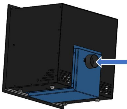
Figura n°4 - Accessorio per incanalare l'ingresso dell'aria dalla parte posteriore
