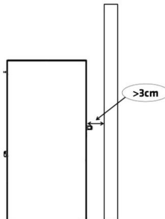
Figura n°3 - Separazione tra l'apparecchio e la parete posteriore
