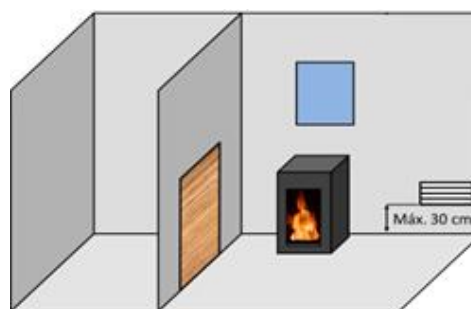
Figura n°11 - Schema orientativo per griglie di ventilazione
