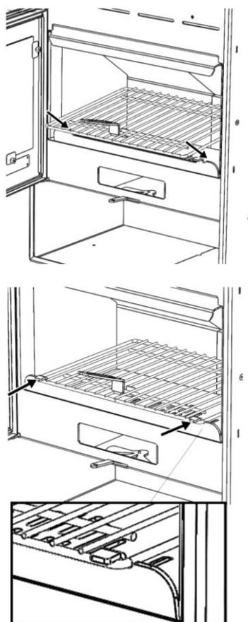
Figura n°11 - Collocazione della griglia nel forno
