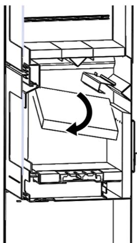
Figura n°15 - *Estrazione dei deflettori in vermiculite*
