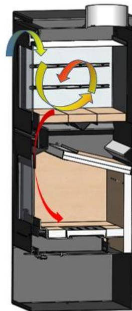
Figura n°9 - Schema sistema di estrazione di vapore
