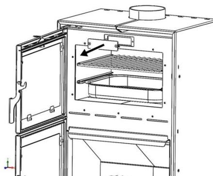
Figura n°16 - Estrazione delle coperture di accesso
