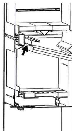
Figura n°13 - Rotazione del rinforzo in acciaio inox
